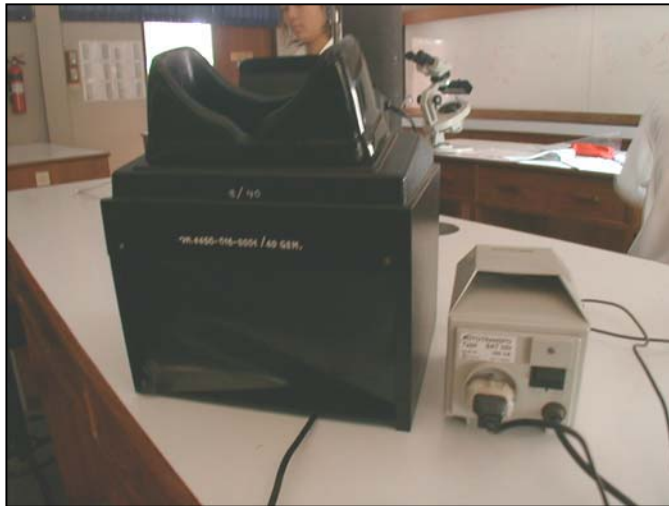
รูปที่ 8 กล้องแสงอัลตราไวโอเลต(UV lamp) สำหรับตรวจสอบการเรืองแสงของพลอย
