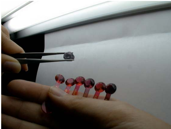
รูปที่ 11 การเทียบสีพลอย กับชุดเทียบสี ภายใต้แสงฟลูออเรสเซนต์
