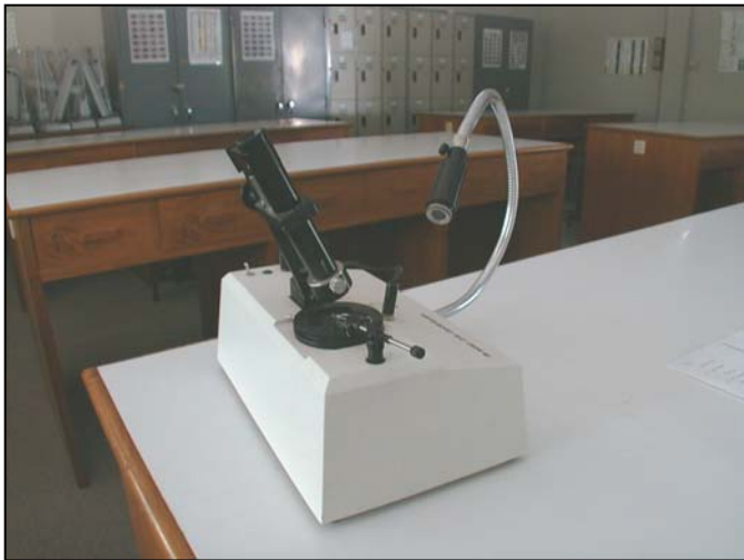
รูปที่ 9 เครื่องสเปกโตรสโคป (spectroscope) สำหรับวัดสเปกตรัมของพลอย
