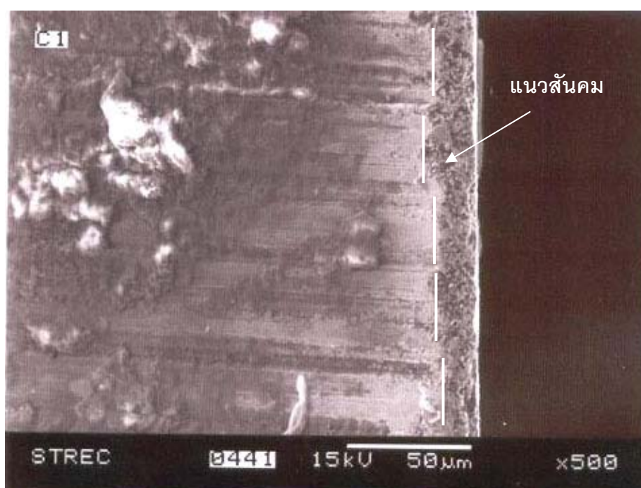
รูปที่ 4.9 ภาพถ่าย SEM ของแนวสันคมมีดที่ได้รับจากผู้ผลิตใบมีดตัดโดยตรงกำลังขยาย 500 เท่า
