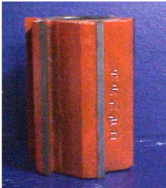
รูปที่ 3.4 ด้านหน้าของใบมีดตัดที่ใช้ในการทดลอง ใบมีดเป็นชนิดพื้นตรง เส้นผ่าศูนย์กลางเท่ากับ 69 มม. ความสูงของใบมีดเท่ากับ 125 มม.
