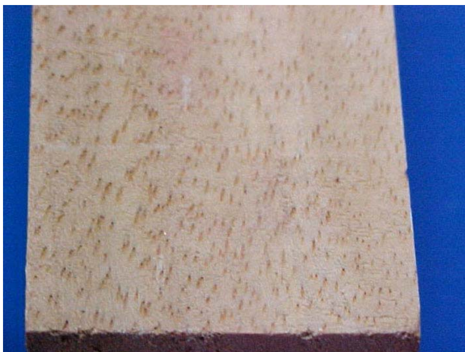
รูปที่ 4.44 ผิวงานที่ได้จากการตัดชิ้นที่ 1 ด้วยอุปกรณ์ควบคุมอัตราการป้อน
