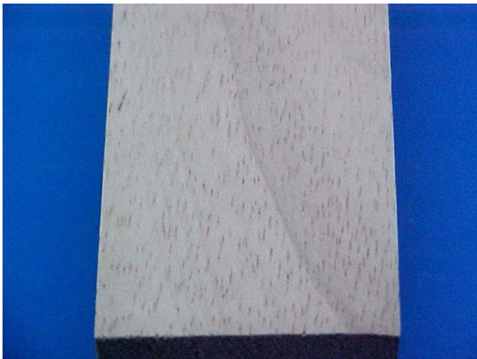
รูปที่ 4.55 ผิวชิ้นงานที่ผ่านการขัดกระดาษทรายเบอร์ 180 ชั้นที่ 1 ของชิ้นงานตัดโดยพนักงาน
