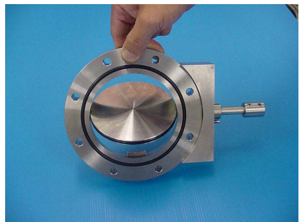
รูปที่ 3.10 วาล์วสุญญากาศสูงของเครื่องเคลือบแบบปีกผีเสื้อ
