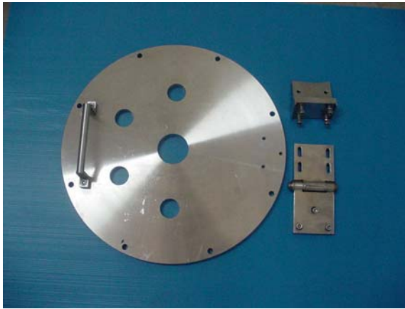
รูปที่ 3.4 ลักษณะของแผ่นปิดบนของเครื่องเคลือบ
