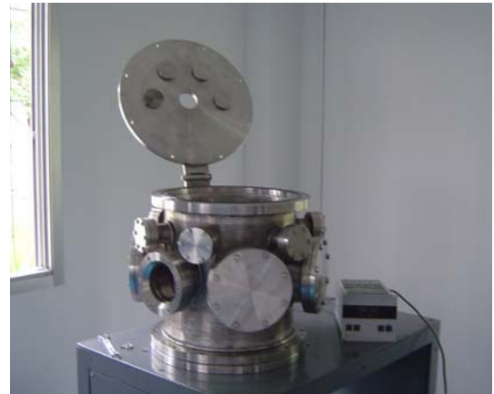
รูปที่ 3.4 ลักษณะของแผ่นปิดบนของเครื่องเคลือบ
