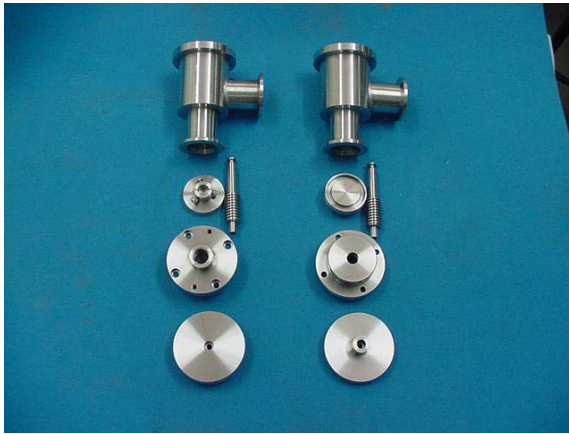
รูปที่ 3.11 วาล์วท้ายและวาล์วหยาบของเครื่องเคลื่อน
