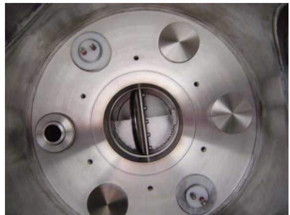
รูปที่ 3.5 ลักษณะของแผ่นฐานของเครื่องเคลือบ
