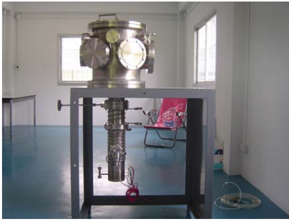
รูปที่ 3.8 เครื่องสูบบแบบเพร็โไอของเครื่องเคลือบ
