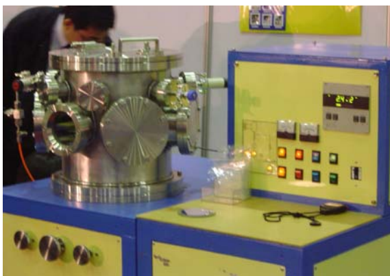
รูปที่ 3.18 ชุดควบคุมระบบการทำงานของเครื่องเคลือบ
