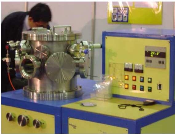
รูปที่ 3.9 มาตรการวัดความดันและการติดตั้งหัววัดความดันของเครื่องเคลือบ
