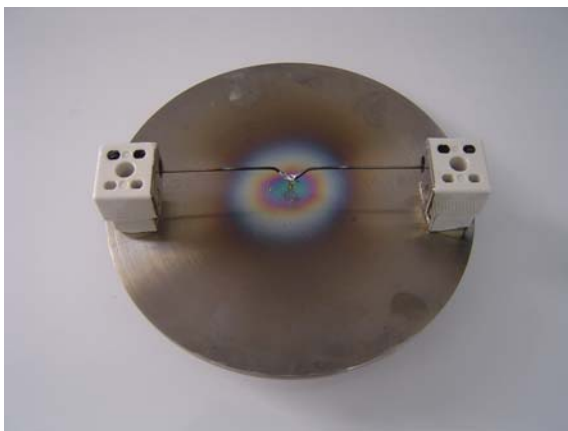
รูปที่ 3.15 การติดตั้งขั้วไฟฟ้าสำหรับจ่ายไฟฟ้าให้กับลวดต้านทาน
