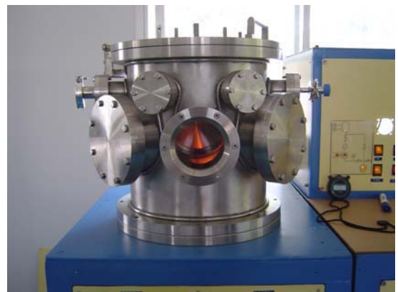
รูปที่ 3.2 เครื่องเคลือบทั้งระบบที่ออกแบบและสร้างขึ้นในโครงการนี้
