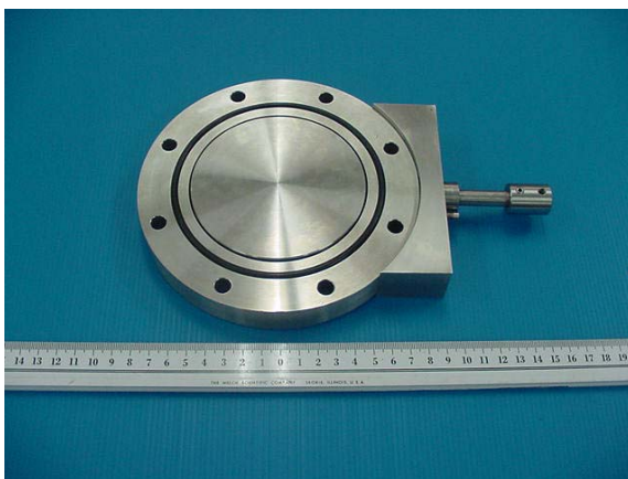
รูปที่ 3.10 วาล์วสุญญากาศสูงของเครื่องเคลือบแบบปีกผีเสื้อ
