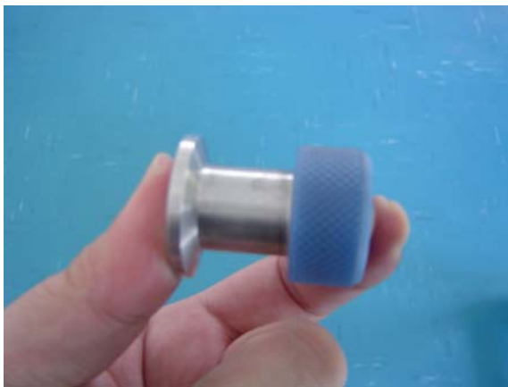
รูปที่ 3.12 วาล์วปล่อยอากาศเข้าภาชนะสุญญากาศของเครื่องเคลื่อน
