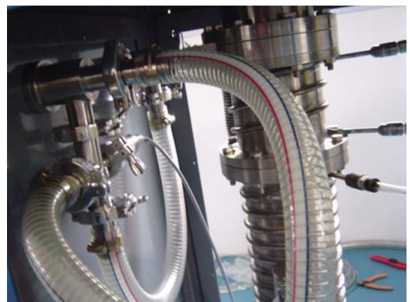
รูปที่ 3.13 การติดตั้งระบบวาล์วท้ายและวาล์วหยาบของเครื่องเคลื่อน
