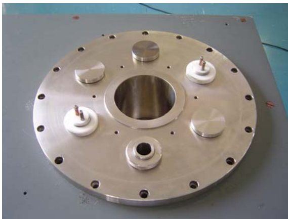
รูปที่ 3.5 ลักษณะของแผ่นฐานของเครื่องเคลือบ
