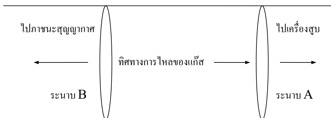
รูปที่ 2.2 การไหลของแก๊สในระบบสุญญากาศ
