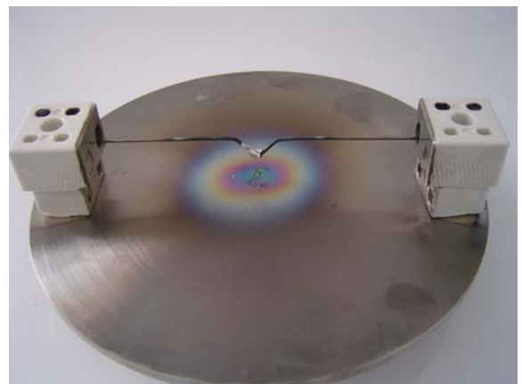
รูปที่ 3.15 การติดตั้งขั้วไฟฟ้าสำหรับจ่ายไฟฟ้าให้กับลวดต้านทาน
