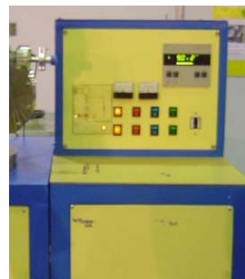
รูปที่ 3.18 ชุดควบคุมระบบการทำงานของเครื่องเคลือบ
