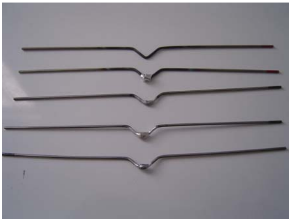
รูปที่ 3.14 ลวดต้านทานสำหรับให้ความร้อนแก่สารเคลือบชนิดที่ดัดแปลงขึ้นใช้ในโครงการ
