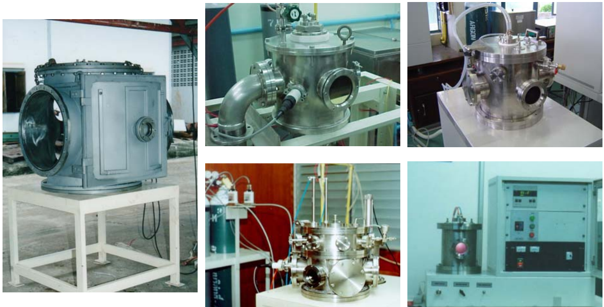
รูปที่ 2.6 ลักษณะของภาชนะปิดของเครื่องเคลือบในสุญญากาศแบบต่างๆ
