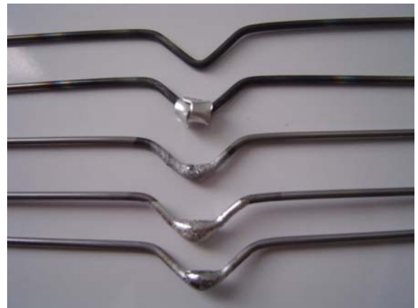
รูปที่ 3.14 ลวดต้านทานสำหรับให้ความร้อนแก่สารเคลือบชนิดที่ดัดแปลงขึ้นใช้ในโครงการ
