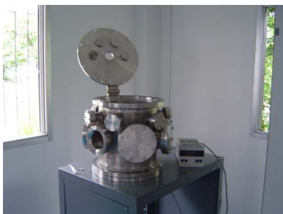
รูปที่ 3.3 ภาชนะสุญญากาศของเครื่องเคลือบ
