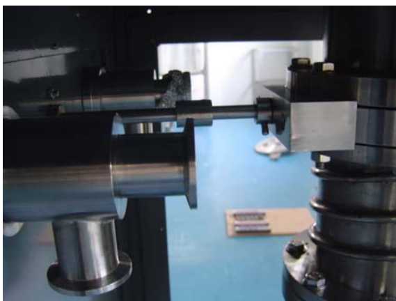
รูปที่ 3.13 การติดตั้งระบบวาล์วท้ายและวาล์วหยาบของเครื่องเคลื่อน
