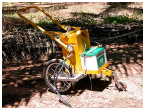
ภาพที่ 28 ชุดปั๊มไฮดรอลิกที่แก้ไขเปลี่ยนเป็นล้อใหญ่
