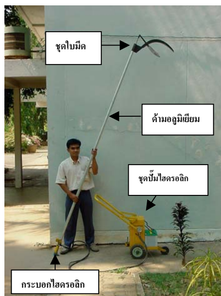
ภาพที่ 16 ชุดปั๊มไฮดรอลิกและด้ามเครื่องต้นแบบ No.1
