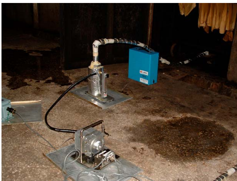
รูปที่ 3.3 ภาพถ่ายการเก็บตัวอย่างเพื่อวัดการกระจายของขนาดอนุภาคเขม่าควัน
