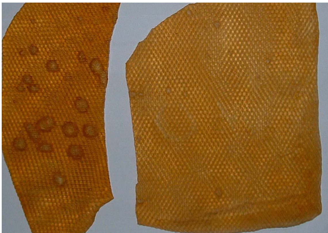
รูปที่ 7.39 ยางฟองจากการรมโดยห้องที่ปรับปรุงแล้วและติดตั้งเครื่องตกตะกอนเชิงไฟฟ้าสถิตย์ (ยางเข้า 28 พย. 2547)
