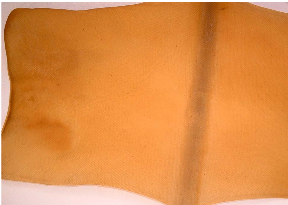
รูปที่ 7.36 ยางดีจากการรมโดยห้องที่ปรับปรุงแล้วแต่ไม่ได้ติดตั้งติดตั้งเครื่องตกตะกอนเชิงไฟฟ้าสถิตย์ (ยางเข้า 31 มค. 2548)
