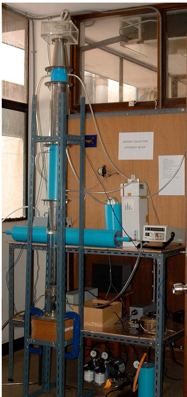
รูปที่ 5.9 ภาพถ่ายชุดการทดลองวัดสมรรถนะของตัวดักจับอนุภาค
