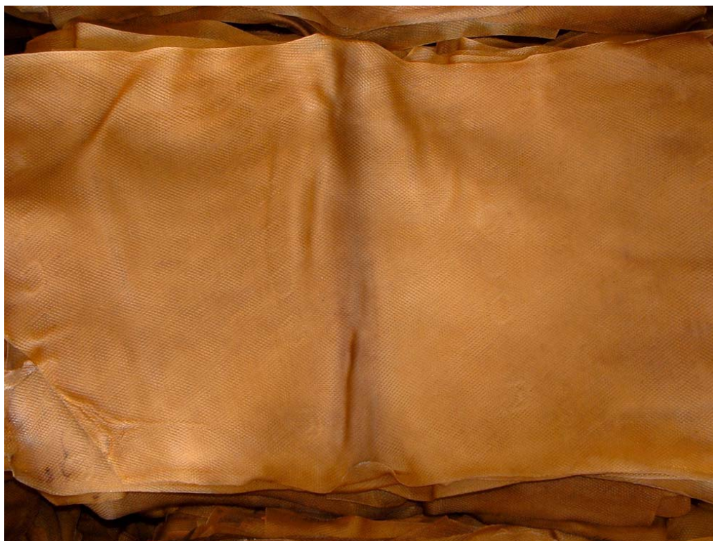
รูปที่ 7.35 ยางดีจากการรมโดยห้องที่ปรับปรุงแล้วแต่ไม่ได้ติดตั้งติดตั้งเครื่องตากตะกอนเชิงไฟฟ้าสฤติย์ (ยางเข้า 24 มค. 2548)
