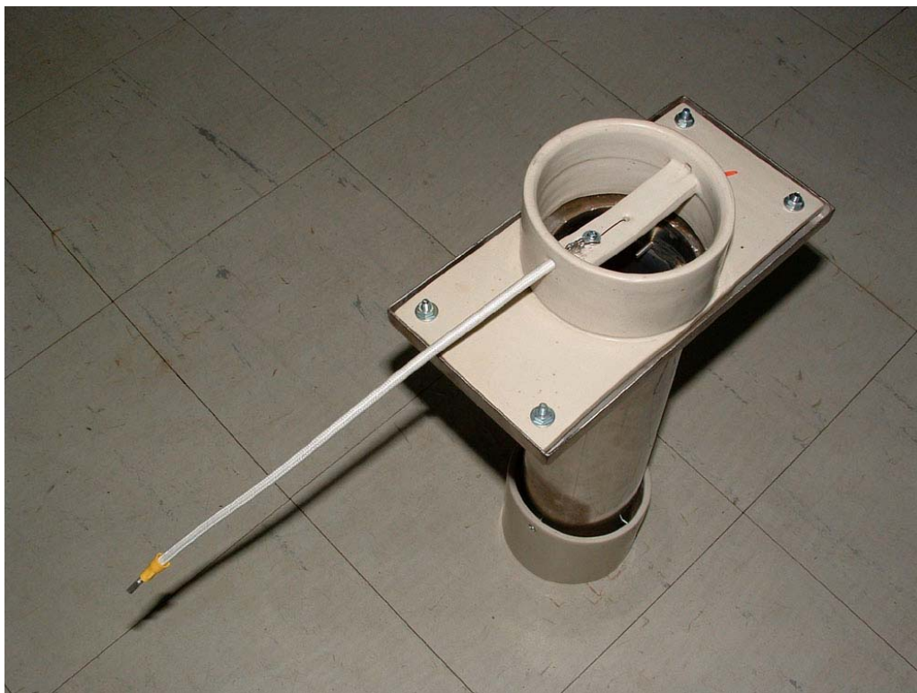
รูปที่ 5.17 เครื่องดักจับอนุภาคแบบตกตะกอนเชิงไฟฟ้าสถิตที่ยังไม่ได้ใช้งาน
