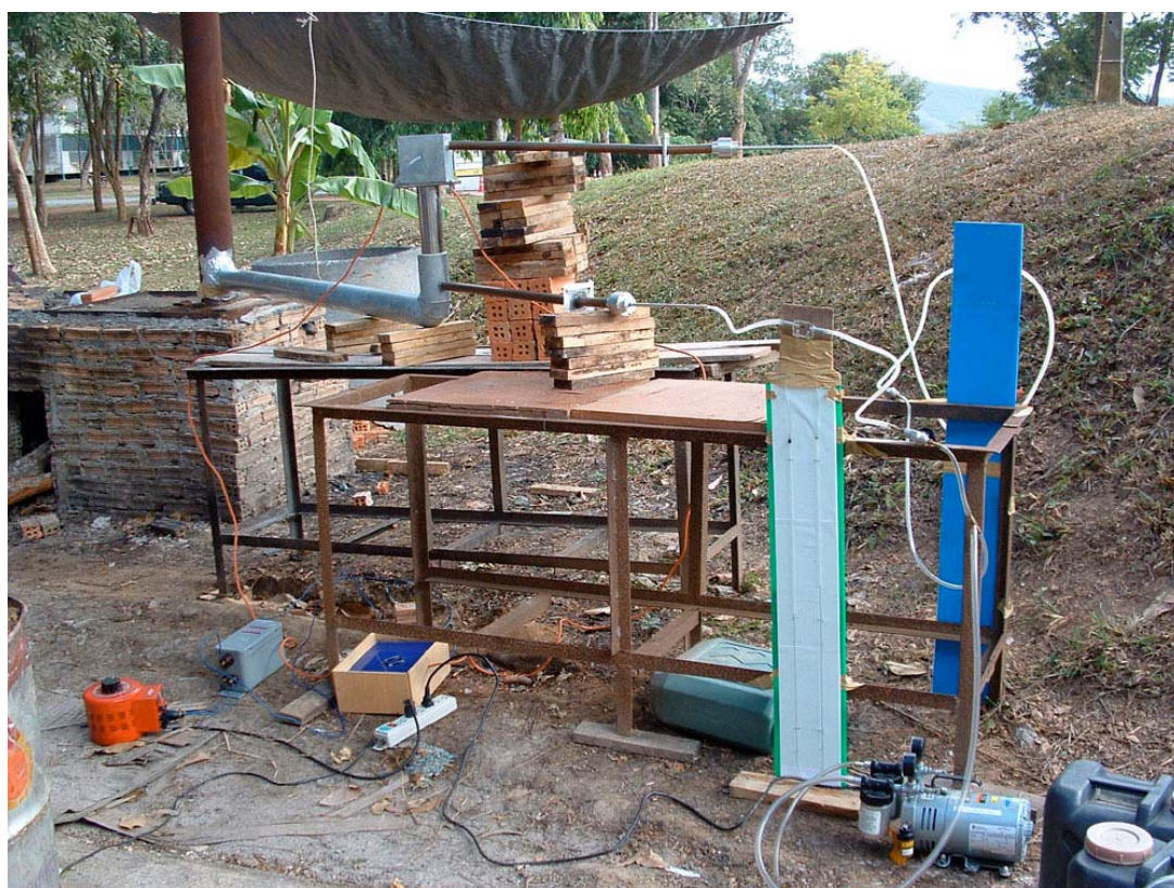
รูปที่ 5.16 ภาพการทดลองเพื่อหาประสิทธิภาพของเครื่องดักจับอนุภาคแบบตกตะกอนเชิงไฟฟ้าสถิตย์
