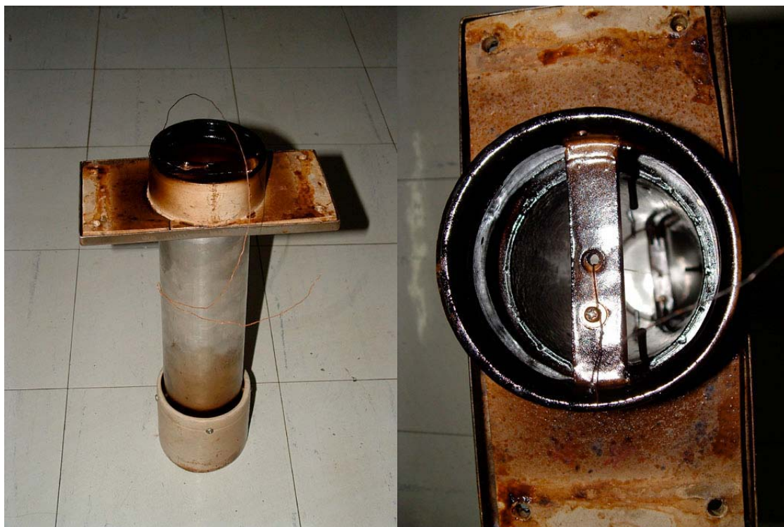
รูปที่ 5.18 เครื่องดักจับอนุภาคแบบตกตะกอนเชิงไฟฟ้าสถิตที่ผ่านใช้งาน 10 ชั่วโมง
