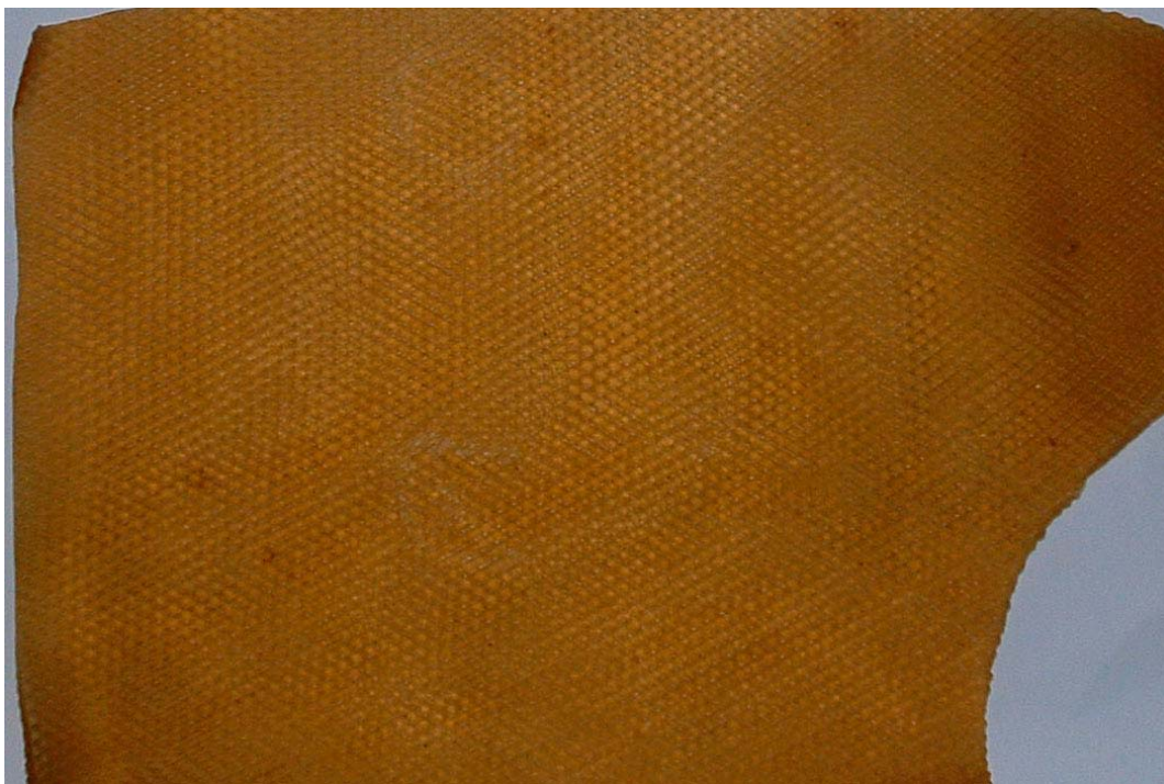
รูปที่ 7.38 ยางดีจากการรมโดยห้องที่ปรับปรุงแล้วและติดตั้งเครื่องตกตะกอนเชิงไฟฟ้าสถิตย์ (ยางเข้า 3 ธค. 2547)
