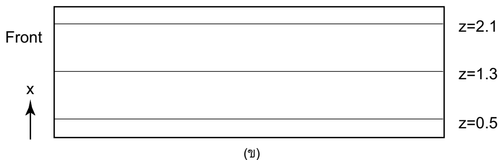
รูปที่ 7.5 ตำแหน่งที่ใช้วัดอุณหภูมิของแก๊สร้อนตามความยาวของห้องรมยาง (ก) ภาพแสดงตำแหน่งในแนวตั้ง (ข) ภาพจากด้านบน
