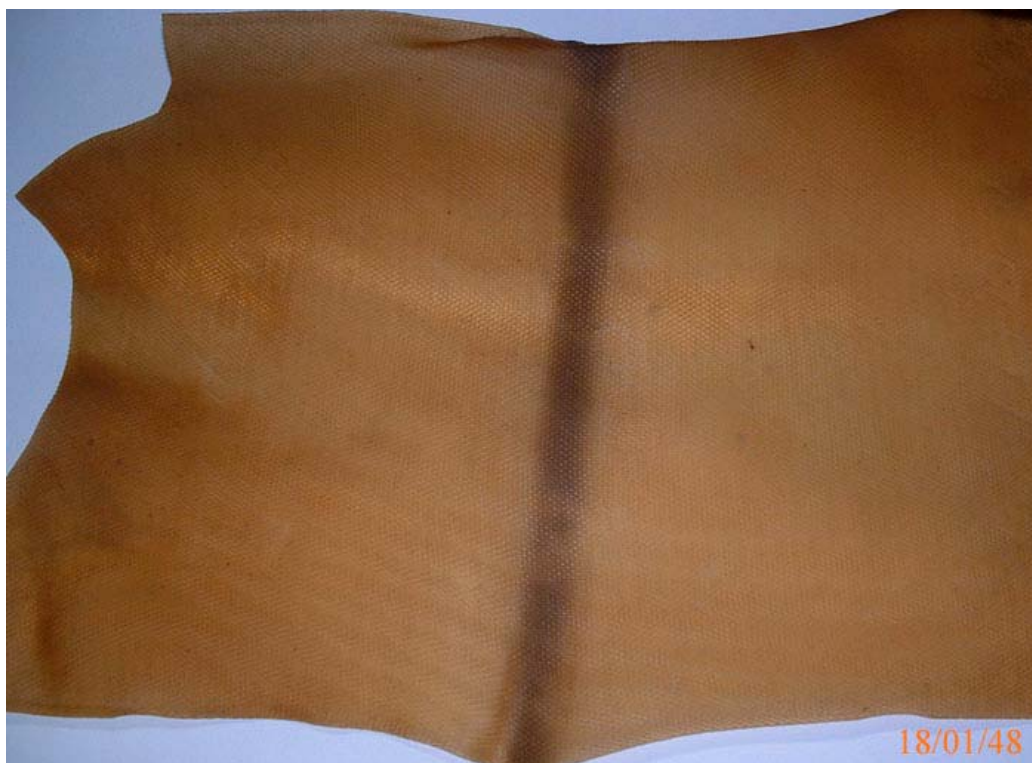
รูปที่ 7.34 ยางดีจากการรมโดยห้องที่ปรับปรุงแล้วแต่ไม่ได้ติดตั้งติดตั้งเครื่องตากตะกอนเชิงไฟฟ้าสฤติย์ (ยางเข้า 18 มค. 2548)
