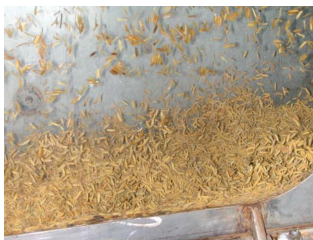
ภาพที่ 4.30 แสดงกระบวนการให้ความร้อนในช่วงของการ Steaming และ Drying ในชุด กระบวนการให้ความร้อนของข้าวหนึ่งด้วยระบบ Fluidization (ก) ข้าวเปลือกขณะเริ่มทำการให้ความร้อน (ข) ข้าวเปลือกความชื้นลดลง (ค) ข้าวเปลือกเกิดการลอยตัวเมื่อความชื้นระเหยออก
