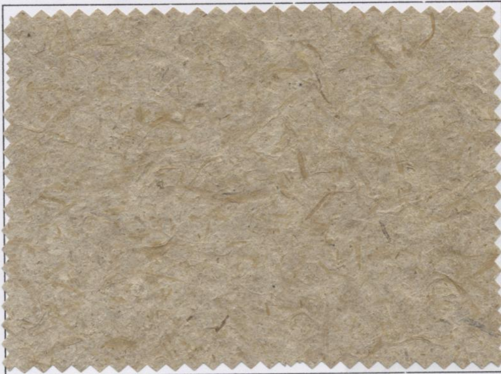
กระดาษจากใบสับปะรดที่ใช้ความร้อนจากฟืน
