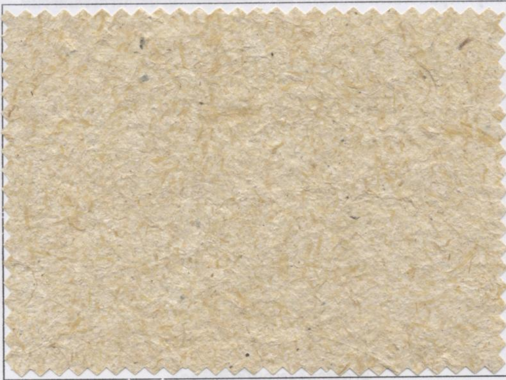
กระดาษจากใบสับปะรดที่ใช้ความร้อนจากแก๊สหุงต้ม
