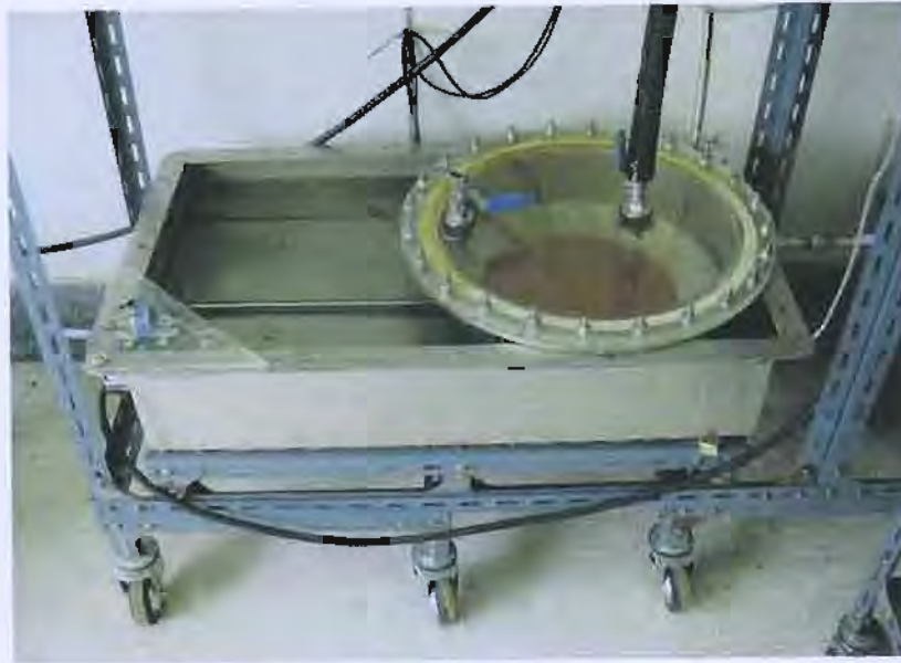
ภาพที่ ข 13 ภาพด้านหน้าของอุปกรณ์ระเหยเฮกเซน
