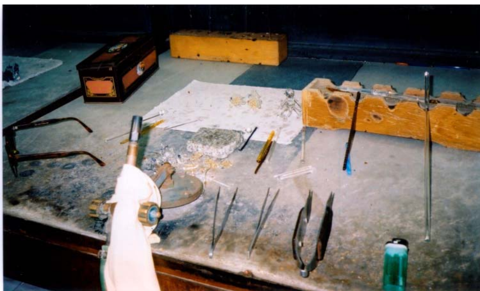
รูปที่ 7 แสดงการใช้แผ่นแอสเบสตอสสำหรับวางชิ้นงาน
