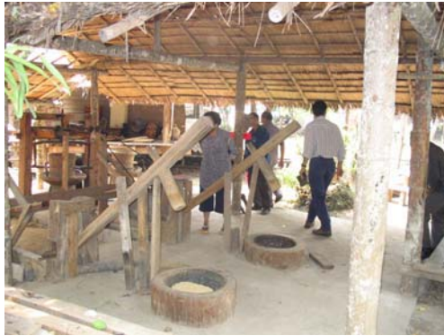
รูปภาพที่ 3.1 ครกกระเดื่อง ซึ่งกลุ่มข้าวกล้องพลังน้ำตกใช้เป็นเครื่องใช้ในการตำข้าว
