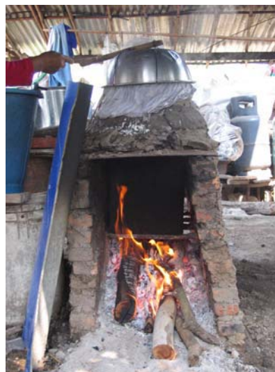
รูปภาพที่ 3.3 เตาอิฐสำหรับได้ข้าวแครงดำของกลุ่มข้าวแครงดำชุมชนหัวเดียด
