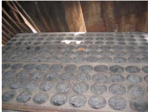
รูปภาพที่ 3.7 แม่พิมพ์น้ำตาลสดซึ่งทำจากไม้ที่กลุ่มน้ำตาลสดบ้านเด่นตาลใช้ในการผลิต
