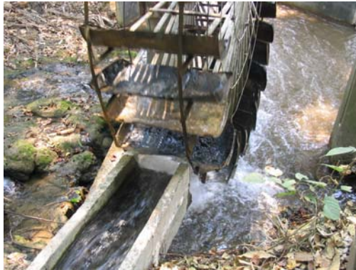
รูปภาพที่ 3.2 กลุ่มข้าวกล้องพลังน้ำตกใช้กังหันพลังน้ำเพื่อหมุนเครื่องกระเทาะเปลือกข้าว และครกกระเดื่องแทนการใช้แรงงานคน
