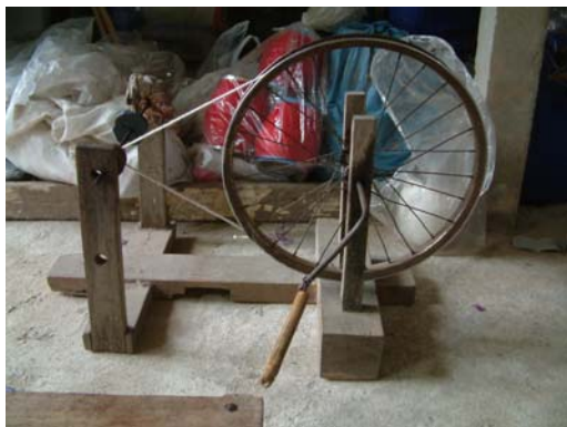
รูปภาพที่ 3.6 กลุ่มทอผ้าบ้านกิ้วพัฒนาใช้ล้อรถจักรยานแทนกรงล้อแบบทางเห็นในการกรอผ้า
