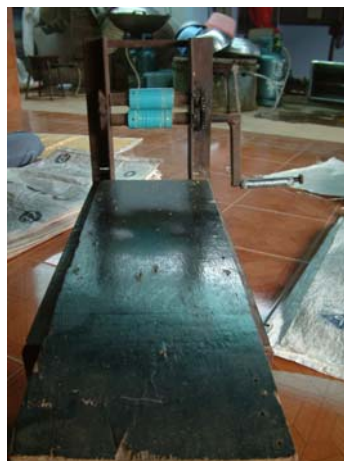
รูปภาพที่ 3.9 เครื่องรีดขนมกรอบเค็มที่ดัดแปลงมาจากเครื่องรีดปลาหมึก ซึ่งกลุ่มแปรรูปอาหารบ้านทุ่งยาวใช้ในการผลิต
