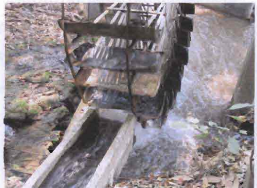
กลุ่มข้าวกล้องพลังน้ำตกใช้กังหันพลังน้ำเพื่อ หมุนเครื่องกระเทาะเปลือกข้าว และครกกระเดื่องแทนการใช้แรงงานคน
