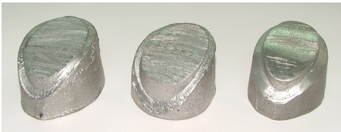
(ก) ฐานรองถ้วยตา รุ่น JR-1006 (ข) ฐานรองถ้วยตา รุ่น 2006 (ค) ฐานรองถ้วยตา รุ่น 981 ภาพที่ 21 ฐานรองถ้วยตา (Support) สำหรับทดสอบการอัดของถ้วยตา รุ่น JR-1006 (ก) รุ่น 2006 (ข) และรุ่น 981 (ค)
