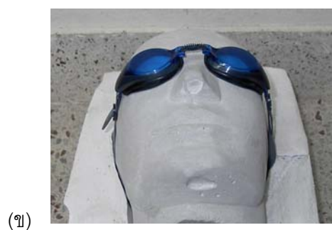
ภาพที่ 23 (ก) รูปปั้นศีรษะจำลองสำหรับทดสอบการกระแทก (ข) เป้ารองศีรษะจำลอง
