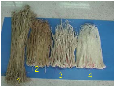
เส้นใยที่ใช้ในการทดลอง (1) หลังตากตามความยาว(2)หลังตากแห้ง(3) หลังล้างด้วยทีโพล (4) หลังฟอกขาว
