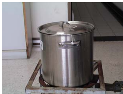
ปิดฝาให้สนิท และมีผ้าเปียกคลุมไว้เพื่อป้องกันแก๊สออกไปจากหม้อฟอก
