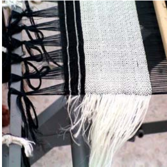
การแยกเส้นใยสับปะรดแล้วเรียงไว้บนสกอตเทปที่ขอบโต๊ะซึ่งคนทอดึงง่าย
