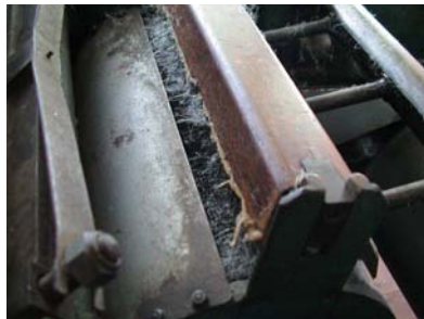
ส่วนหัวที่กำจัดเส้นใยที่ค้างอยู่บน Doffer
