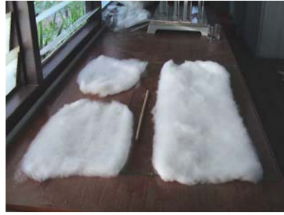
แผ่น web ที่ลอกได้ขนาด 5 กรัมต่อ 38 เซนติเมตร
