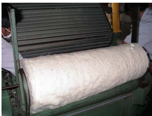
รูปที่ 16 เครื่องสาวเส้นใยระดับอุตสาหกรรม
