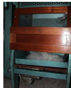
เส้นใยที่แข็งและหยาบซึ่งจะตกลง ส่วน conveyyor ด้านหน้า
