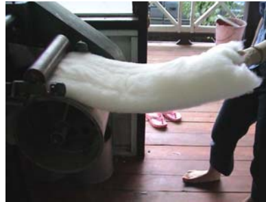
ทำการลอกแผ่น web ออกจาก cylinder อลูมิเนียม
