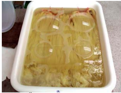
หลังแช่น้ำด่างเส้นใยเปลี่ยนเป็นสีเหลือง
