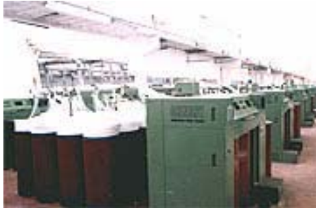
รูปที่ 17 เครื่องรีดปุย (drawing) ระดับอุตสาหกรรม
