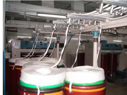
รูปที่ 17 เครื่องรีดปุย (drawing) ระดับอุตสาหกรรม
