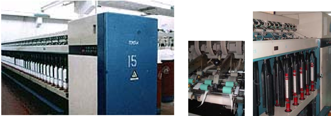
รูปที่ 18 เครื่อง roving ระดับอุตสาหกรรม
