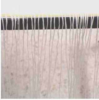
การแยกเส้นใยสับปะรดแล้วเรียงไว้บนสกอตเทปที่ขอบโต๊ะซึ่งคนทอดึงง่าย
