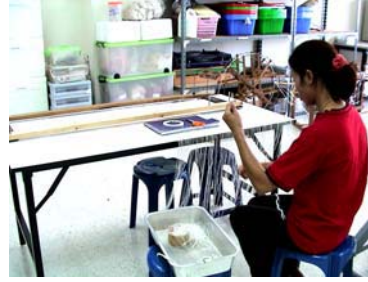
การแยกเส้นใยสับปะรดแล้วเรียงไว้บนสกอตเทปที่ขอบโต๊ะซึ่งคนทอดึงง่าย
