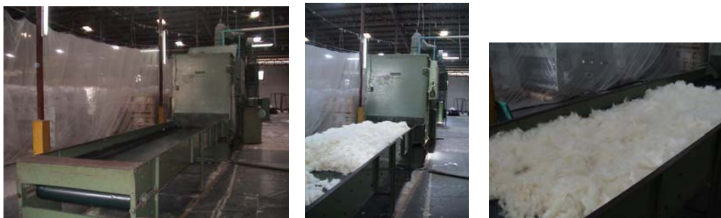
รูปที่ 14 เครื่อง Blow room ระดับอุตสาหกรรม
