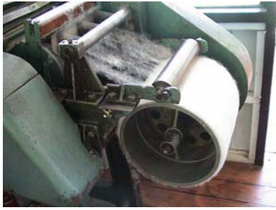
แผ่น web บน cylinder อลูมิเนียม ซึ่งจะ สะสมจนได้ขนาดที่ต้องการ
