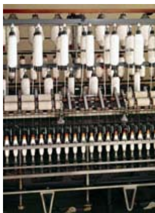
รูปที่ 19 เครื่อง ring spinning ระดับอุตสาหกรรม
