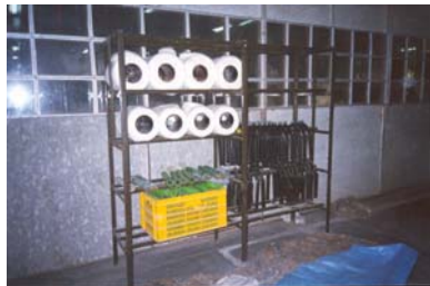
ชั้นวางหลอด Roving, แกน Flyer และหลอด Superlap
