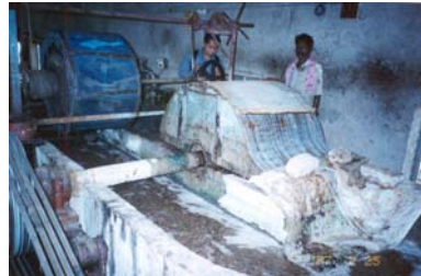
ทำให้เป็นเยื่อโดยตีในเครื่องตีเยื่อ
