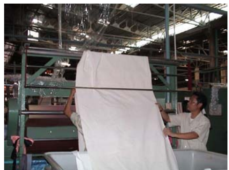
เครื่อง stentex3 สำหรับการตกแต่งผ้าให้นุ่มด้วยสารปรับนุ่ม
