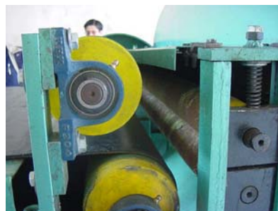
ช่องว่างระหว่างลูกกลิ้งป้อนใบชุดกับ ลูกกลิ้งจับยึด
