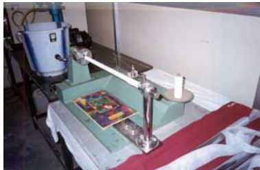
เครื่องอัดยื่นท่อหลอดลมเทียมที่ SITRA ทำการวิจัย
