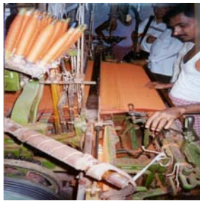
เครื่องจักรทอผ้าใช้กระสวยที่เสริมด้วยหัวยกตะกรอคียบี้ ทำลวดลายริมผ้าทั้งสองด้าน
