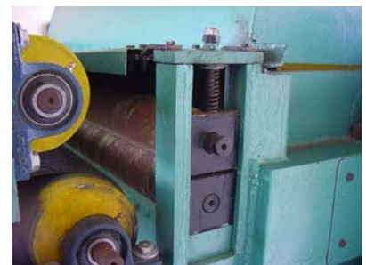
วิธีการให้แรงจับยึดใบโดยใช้สปริงกด
