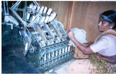
เครื่องปั่นด้ายแบบ Ring spinning machine ด้วยมือ ขนาด 8 แกน ผลิตเส้นด้ายเบอร์ 16 S Ne
