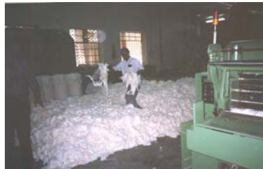
เปิดเบลฝ้าย (Opening section) หรือ ผสมเส้นใยโดยใช้แรงงาน
