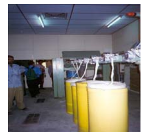
ด้านหลังเครื่อง Drawing และถังบรรจุ Sliver
