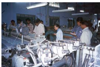
เครื่องจักรทอผ้าแบบก้านส่ง(rapier picking)อินเดียนำมา เป็นต้นแบบเพื่อการวิจัยพัฒนาสร้างเครื่องใหม่
