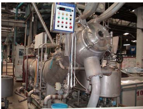
เครื่อง jet สำหรับการทำความสะอาดและฟอกขาว และการกำจัดขน
