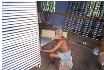
เครื่องสับด้ายยืนและราวตั้งหลอดด้ายแบบ direct warping
