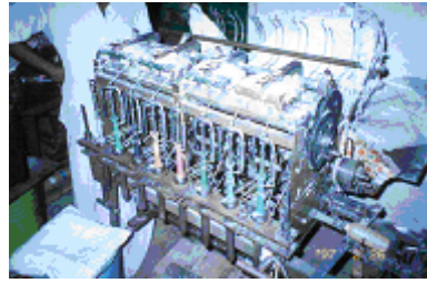
รูปที่ 19 เครื่อง Roving machine ขนาดเล็กสำหรับผลิต roving ที่ใช้กับเครื่องปั่นด้าย แบบ Ring spinning machine ด้วยมือ
