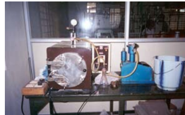
เครื่องอัดยื่นท่อหลอดลมเทียมที่ SITRA ทำการวิจัย
