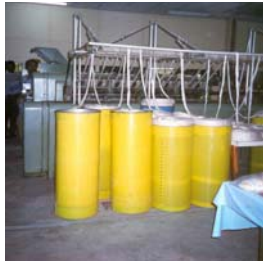
เครื่อง Roving ใช้สำหรับลดขนาดเส้น Sliver เพื่อให้เหมาะสมกับเบอร์ด้ายที่จะผลิต
