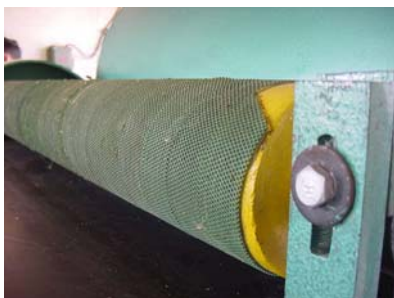
พื้นผิวของลูกกลิ้งที่ออกแบบให้มีการ ยึดจับที่ดี(Friction )
