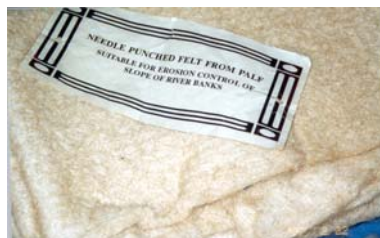
รูปที่ 8 ผ้าไม่ทอที่ผลิตจากใยสับปะรด ด้วยวิธี Needle Punched Felt
