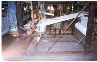
กี่ทอผ้าปูที่นอน แบบ 4 ตะกอ 4 แท้เหยียบ
