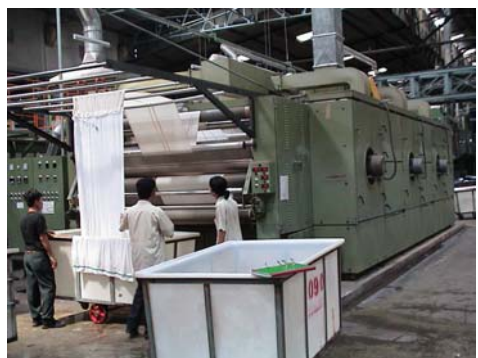
เครื่อง jet สำหรับการทำความสะอาดและฟอกขาว และการกำจัดขน
