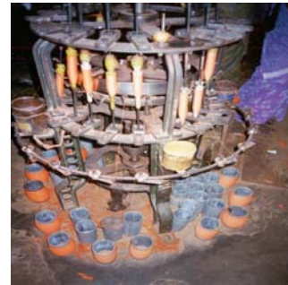
เครื่องกรอด้วยพุ่ง ใส่กระสวยแบบวงกลม ขนาด 12 แกน
