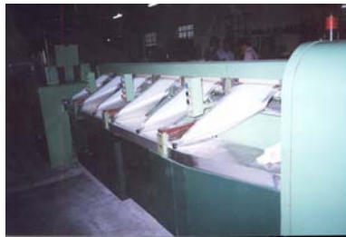
เครื่องหวีเส้นใยเพื่อทำให้เส้นใยสะอาดขึ้นและสาวเส้นใยสั้นทิ้ง
