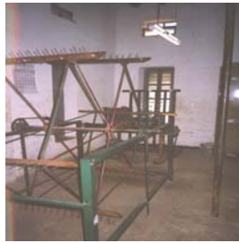
Horizontal warper สำหรับเตรียมเส้นไหมยืน
