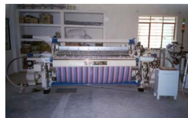
เครื่องจักรทอผ้าแบบ Flexible Rapier แบบก้านส่งด้ายพุ่ง
