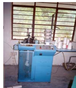
เครื่องถักผ้าแบบวงกลมเป็นเครื่องขนาดเล็ก เพื่อใช้ทดลองค่า ความตึงของเส้นด้ายที่เหมาะสมต่อการใช้งานจริง
