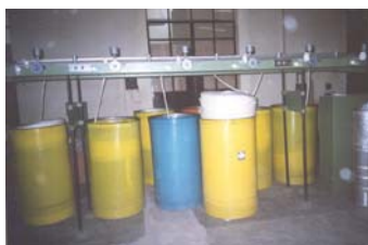
ราวลำเลียงเส้น Sliver ป้อนเข้าเครื่อง Drawing machine
