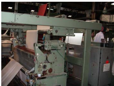
เครื่อง stentex3 สำหรับการตกแต่งผ้าให้นุ่มด้วยสารปรับนุ่ม
