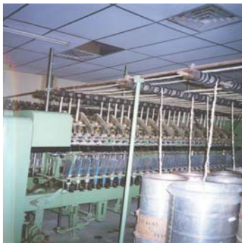
สายพานลำเลียงเส้นใยเข้าเครื่องผสม เส้นใย ปอผสมฝ้ายอัตรา 70: 30
