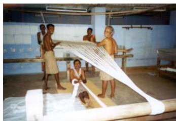
รูปที่ 24 การสับด้ายยืนลงบน빔 (Beam)
