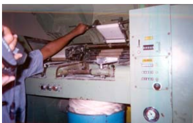
เครื่อง Drawing machine ใช้สำหรับ เรียงเส้นใย ผลผลิตที่ได้คือ Sliver
