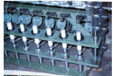
ระบบขับเคลื่อนและตีเกลียวเส้นด้ายของเครื่องปั่นด้าย Ring spinning machine ด้วยมือ
