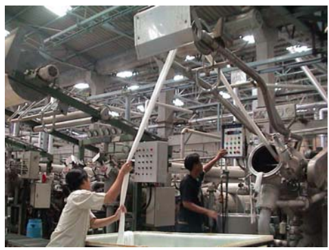
เครื่อง jet สำหรับการทำความสะอาดและฟอกขาว และการกำจัดขน
