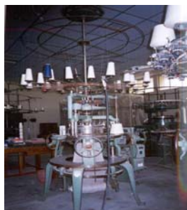
เครื่องถักผ้าทรงกลม (Circular knitting machine) สำหรับผลิตผ้ายี่ดชนิดผ้า Rib
