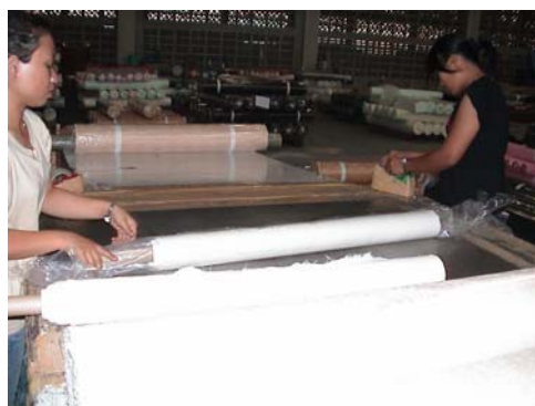
เครื่อง stentex3 สำหรับการตกแต่งผ้าให้นุ่มด้วยสารปรับนุ่ม
