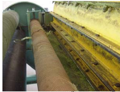
ช่องว่างระหว่างลูกกลิ้งชุดกับลูกกลิ้ง ป้อนใบ
