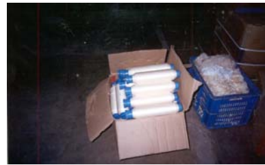
หลอดบรรจุเส้น Roving เพื่อใช้ในการปั่นด้ายของเครื่อง Ring spinning machine
