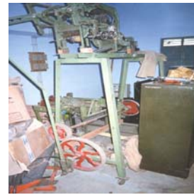
แท่นสาธิตการทำงานและเครื่องคอบบี้เพื่อใช้สร้างลวดลาย ผ้าทอ เป็นผลงานต้นคิดของ SITRA
