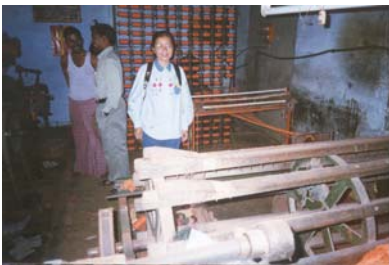
เครื่องสับด้ายยืนแบบ Sectional warping (ผ้าลายรีว) มีอุปกรณ์ม้วนด้ายยืนที่ควรนำมาประยุกต์ใช้ในไทย
