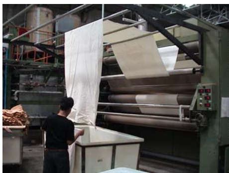
เครื่อง jet สำหรับการทำความสะอาดและฟอกขาว และการกำจัดขน
