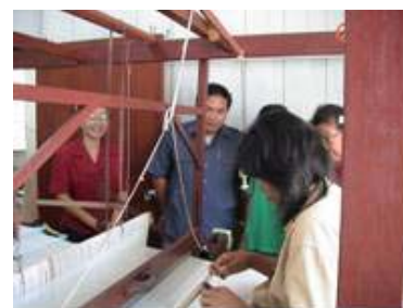
การทอผ้าชนิดโครงถี่ 2 ตะกอโดยใช้เส้นฝ้ายเป็นเส้นยืน
