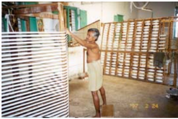
เครื่องสับด้ายยืนและราวตั้งหลอดด้ายแบบ direct warping
