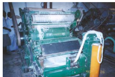
รูปที่ 18 เครื่อง Roving machine ขนาดเล็กเพื่อผลิต Sliver สำหรับปั่นด้ายแบบ Ring spinning machine ด้วยมือ
