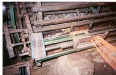
เครื่องสับด้ายยืนและราวตั้งหลอดด้ายแบบ direct warping
