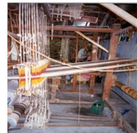
แผงตะกรอสำเร็จรูป (แดง เหลือง ขาว) ใช้งานได้นาน และสะดวกต่อการสับ ลายโครงสร้าง กี่นี้มี 8 ตะกอ
