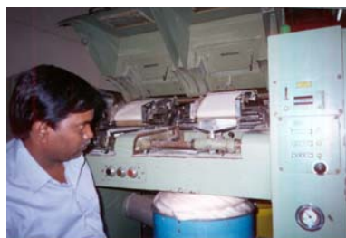
แสดงลักษณะชุดลูกกลิ้งสำหรับ ควบคุมและรีดเส้นใย
