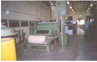
ด้านหลังเครื่องสาวเส้นใยแสดงการ ป้อนแผ่นเส้นใยที่ได้จาก Blow room
