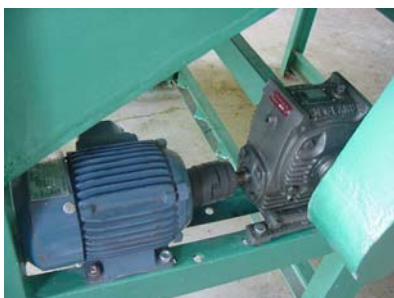
การส่งกำลังจากมอเตอร์ ไฟฟ้ากับชุดเฟืองทด
