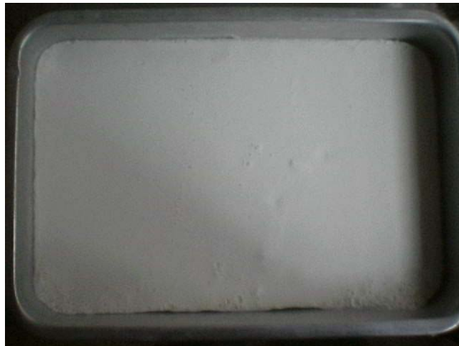
ภาพที่ 4.6 ยางแผ่นดิบเมื่อผสมกรด 9% ปริมาณ 300 cc กับน้ำยาง 1,000 cc
