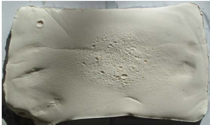
ภาพที่ 4.1 แผ่นยางที่ได้จากการผสมโดยใช้ใบพัดโค้ง กรดฟอร์มิก 1.5% ปริมาณ 125 cc
