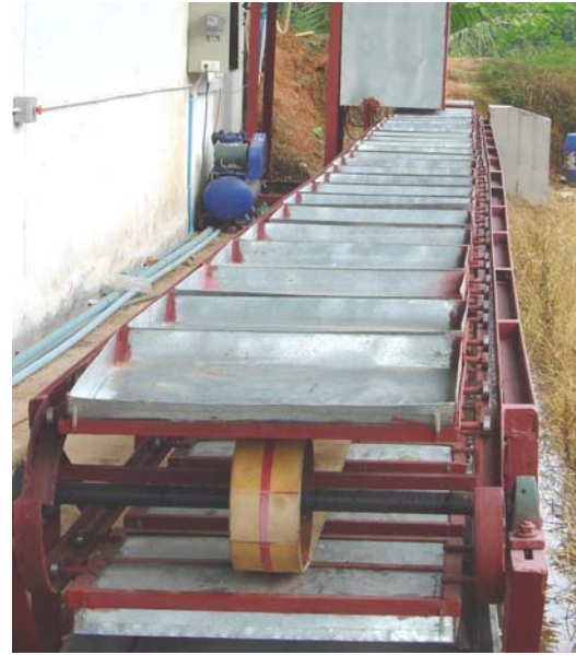
ภาพที่ 3.8 ชุดลำเลียงตะกที่ทดลองใช้ที่ สหกรณ์กองทุนสวนยางลำใหญ่พัฒนาจำกัด
