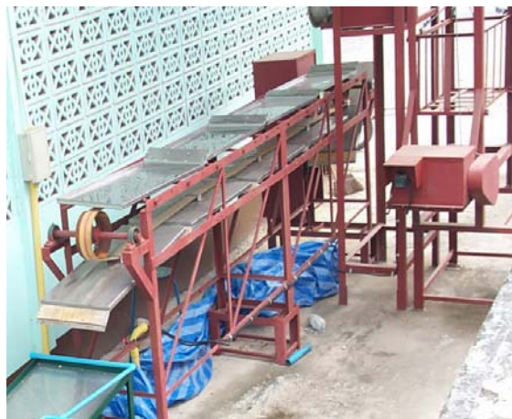
ภาพที่ 3.2 ระบบลำเลียงตะกุงของเครื่องผลิตยางแผ่นดิบกึ่งอัตโนมัติ
