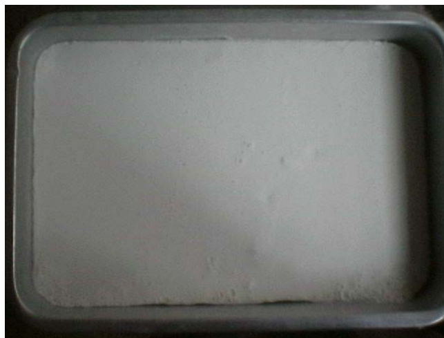
ภาพที่ 4.6 ยางแผ่นดิบเมื่อผสมกรด 9% ปริมาณ 300 cc กับน้ำยาง 1,000 cc
