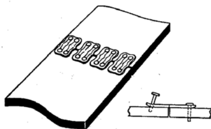
ภาพที่ 2.13 การต่อด้วยแผ่นเหล็ก
