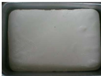
ภาพที่ 4.10 ยางแผ่นดิบเมื่อผสมกรด 9% ปริมาณ 400 cc กับน้ำยาง 1,000 cc
