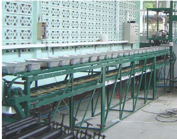
ภาพที่ 3.3 ระบบลำเลียงตะกของเครื่องผลิตยางแผ่นดิบอัดโนมัต ที่วิทยาเขตนครศรีธรรมราช
