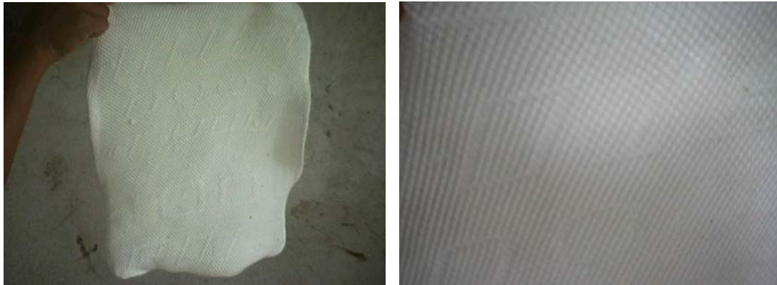
ภาพที่ 4.7 ยางแผ่นดิบที่รีดแล้ว (กรด 9% ปริมาณ 300 cc ผสมกับน้ำยาง 1,000 cc)
