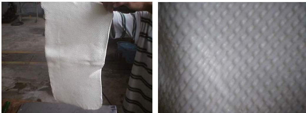
ภาพที่ 4.11 ยางแผ่นดิบที่รีดแล้ว (กรด 9% ปริมาณ 400 cc ผสมกับน้ำยาง 1,000 cc)
