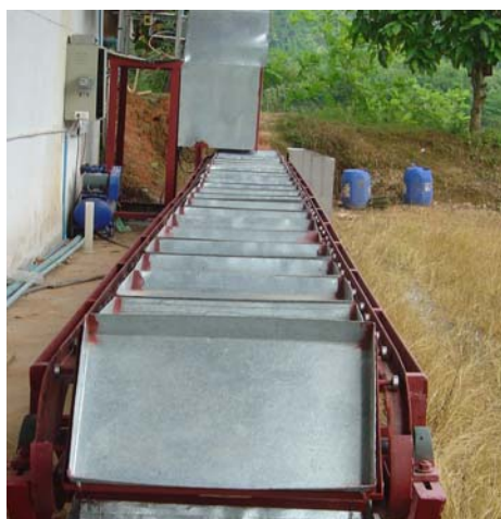
ภาพที่ 3.4 ระบบลำเลียงตะกของเครื่องผลิตยางแผ่นดิบอัดโนมัต ที่สหกรณ์กองทุนสวนยางอำเภอพัฒนาจำกัด
