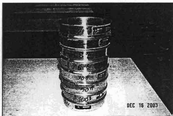
ภาพที่ จ.3.1 ขนาดของตะแกรงที่ใช้ใน การทดสอบการกระจายขนาดผล
