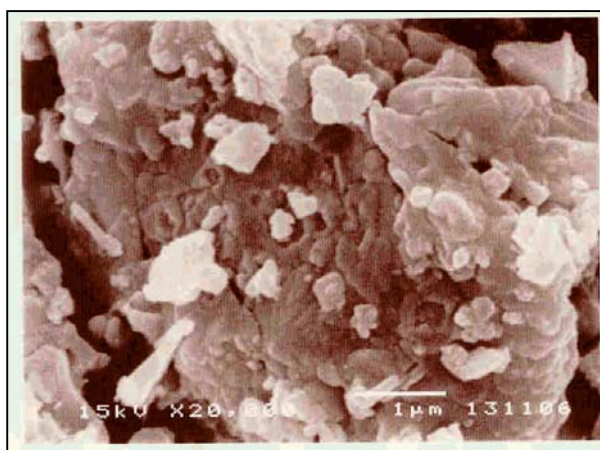
ภาพที่ 5.6 ภาพขยายอนุภาคปูนซีเมนต์ที่กำลังขยาย 20,000 เท่า
