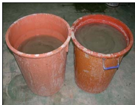
ภาพที่ 4.9 การเก็บน้ำสลัดจ์ใส่ถังเพื่อ เตรียมนำไปผสมคอนกรีต
