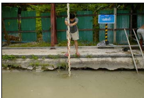
ภาพที่ 4.3 การวัดความลึกของตะกอนและน้ำในบ่อตกตะกอน
