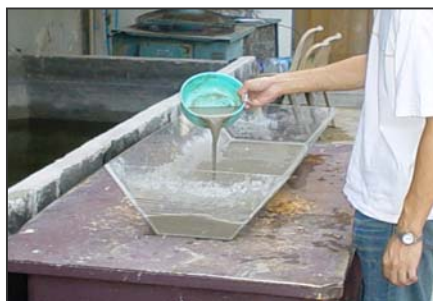
ภาพที่ 4.7 การเทน้ำสลัดจ์ในอ่างจำลอง
