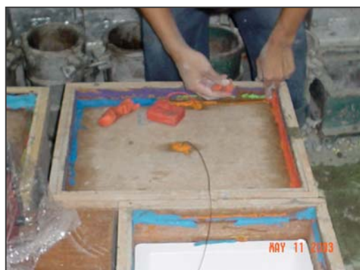
ภาพที่ จ.34 การย่นแนวรอยต่อด้วยดินน้ำมัน
