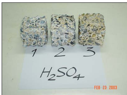
ภาพที่ จ.54 ตัวอย่างคอนกรีตที่ถูกกัดกร่อน จากกรดซัลฟูริก
