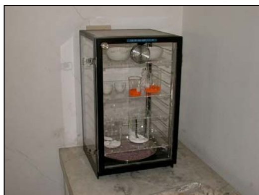
ภาพที่ จ.8 ตู้ควบคุมความชื้น
