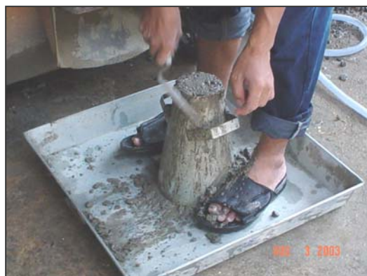
ภาพที่ จ.26 การปาดผิวหน้าคอนกรีตให้เรียบ
