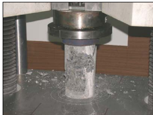
ภาพที่ จ.37 ตัวอย่างกำลังรับแรงอัด ภายหลังการทดสอบ
