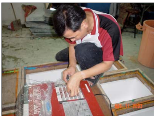
ภาพที่ จ.35 การต่อสายเทอร์โมคัปเปิลเข้ากับเครื่อง Data Logger
