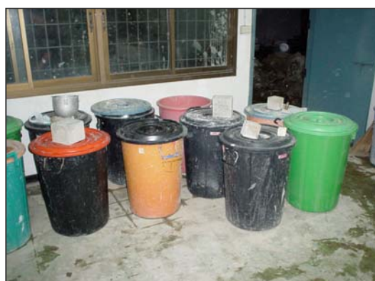
ภาพที่ จ.53 การวางถังทดสอบ การกัดกร่อนจากกรด
