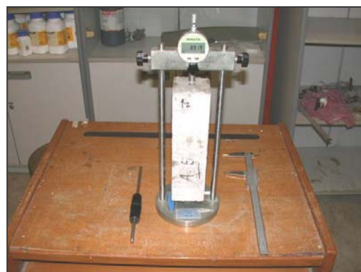
ภาพที่ จ. 49 การวัดแท่งตัวอย่างคอนกรีต
