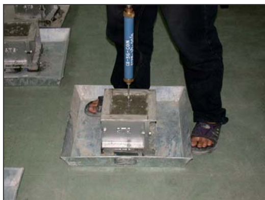
ภาพที่ จ.28 การทดสอบระยะเวลาการก่อตัวของคอนกรีต
