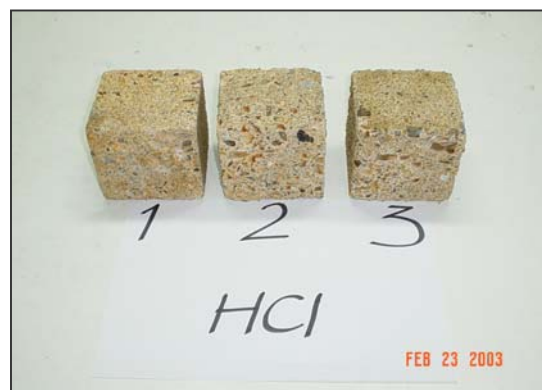
ภาพที่ จ.55 ตัวอย่างคอนกรีตที่ถูกกัดกร่อน จากกรดไฮโดรคลอริก
