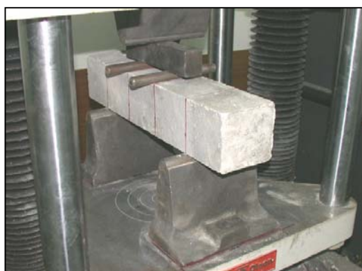
ภาพที่ จ.40 การติดตั้งตัวอย่างทดสอบแรงดัด
