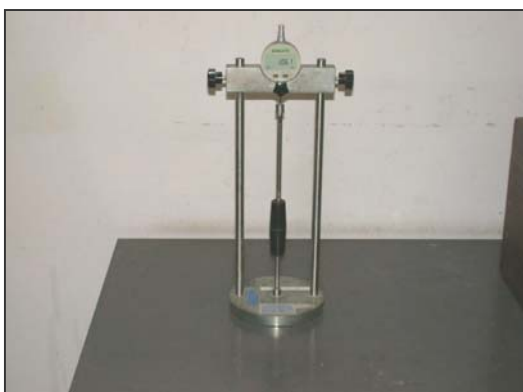
ภาพที่ จ.48 การปรับเทียบความยาวกับแท่งทดสอบ
