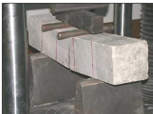
ภาพที่ จ.41 ตัวอย่างทดสอบแรงดัด ภายหลังการทดสอบ
