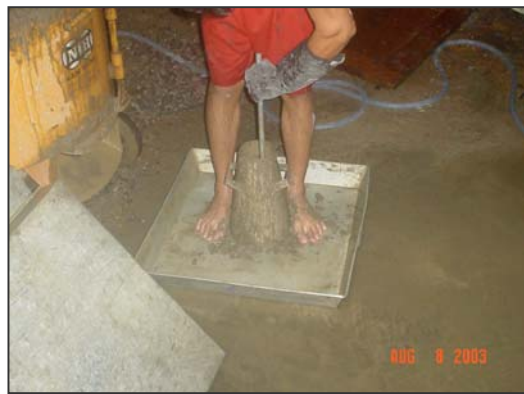
ภาพที่ จ.25 การกระทุ้งคอนกรีต
