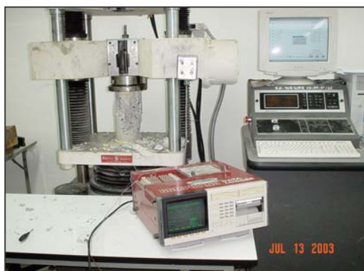
ภาพที่ จ.44 การติดตั้งตัวอย่าง เข้ากับเครื่องทดสอบ
