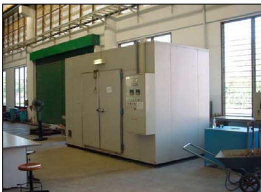
ภาพที่ จ.16 ตู้บ่มที่ควบคุมอุณหภูมิและความชื้น
