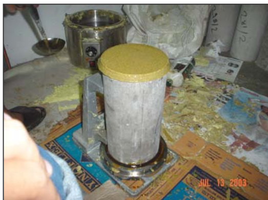
ภาพที่ จ.42 การแปะหัวคอนกรีตด้วยกัมมะถัน
