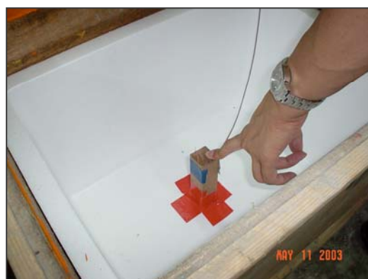
ภาพที่ จ.30 การติดตั้งเทอร์โมคัปเปิลวัดอุณหภูมิ
