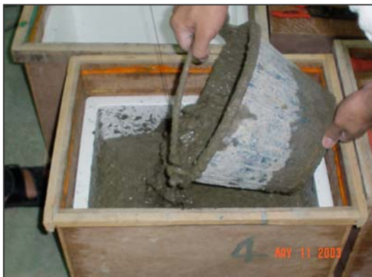
ภาพที่ จ.31 การเทคอนกรีตลงในกล่องโฟม
