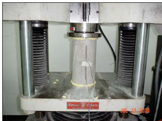
ภาพที่ จ.43 การติดตั้ง Strain Gauge
