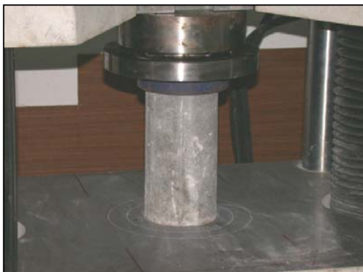
ภาพที่ จ.36 การติดตั้งตัวอย่างทดสอบ กำลังรับแรงอัด
