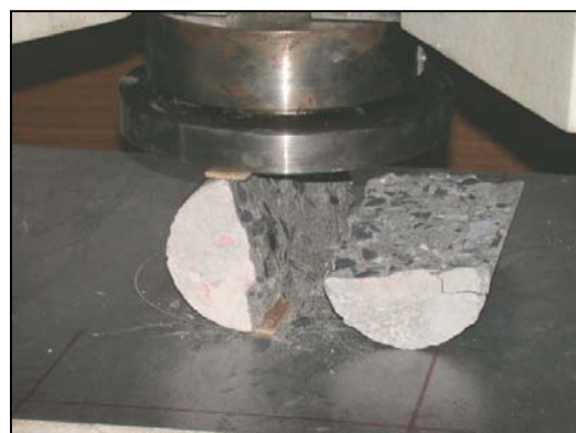
ภาพที่ จ.39 ตัวอย่างทดสอบแรงดึง ภายหลังการทดสอบ
