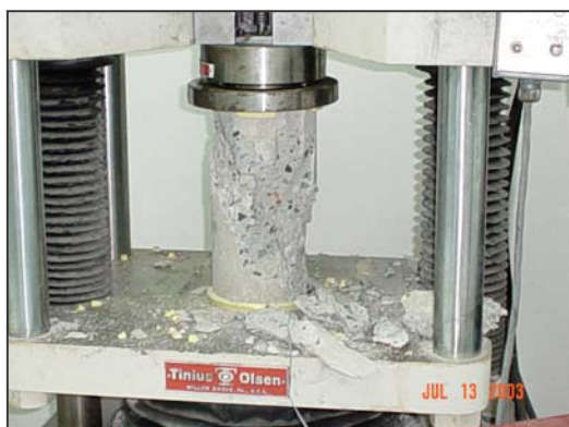
ภาพที่ จ.45 ตัวอย่างคอนกรีตภายหลังการ ทดสอบจนวิบัติ
