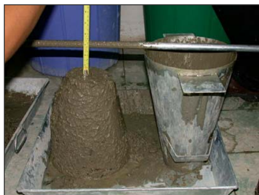
ภาพที่ จ.27 การวัดค่าการยุบตัวของคอนกรีต
