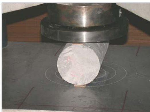
ภาพที่ จ.38 การติดตั้งตัวอย่างทดสอบ แรงดึงแบบผ่าซีก
