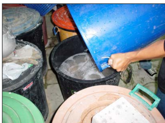
ภาพที่ จ.52 การเทสารละลายกรด ในถังแช่คอนกรีต
