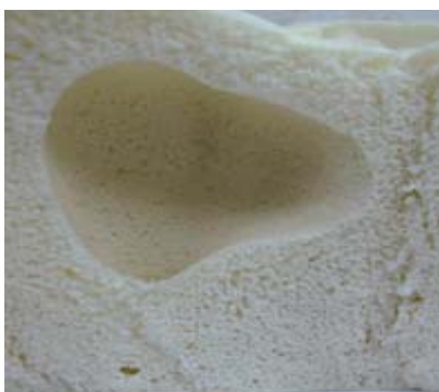
รูปที่ 4.4 แสดงลักษณะฟองอากาศขนาดใหญ่เกิดขึ้นภายในเนื้อโฟมเมื่อใช้ SSF น้อยกว่า 0.04 phr (2 ส่วน)
