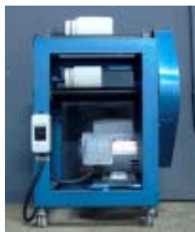
รูปที่-2 แสดงเครื่องบดสารเคมี (ball mill) ที่ออกแบบและจัดสร้างขึ้นในงานวิจัยนี้
