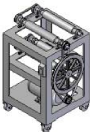
รูปที่-2 แสดงเครื่องบดสารเคมี (ball mill) ที่ออกแบบและจัดสร้างขึ้นในงานวิจัยนี้
