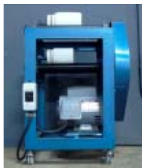
รูปที่-2 แสดงเครื่องบดสารเคมี (ball mill) ที่ออกแบบและจัดสร้างขึ้นในงานวิจัยนี้
