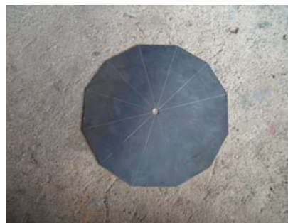
รูปที่ 4.4 การวาดแบบลงเหล็กแผ่นขนาดบางเพื่อทำแบบ
