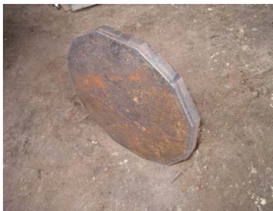
รูปที่ 4.5 ฐานมิดที่ผ่านการตัดด้วยเครื่องตัดแก๊สอัตโนมัติ
