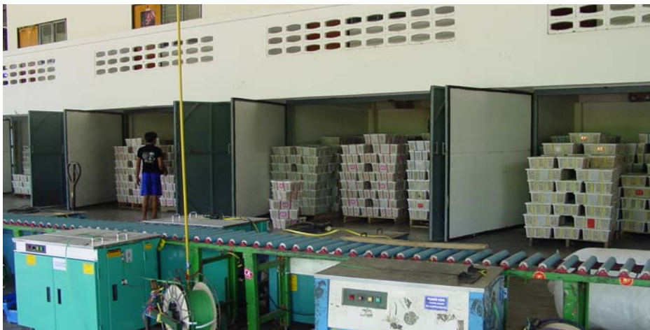
ภาพที่ 3.30 การจัดวางตะกร้าลำไยบนแท่นวาง แล้วนำไปรมซัลเฟอร์ไดออกไซด์ในห้องรมที่ได้รับการรับรองจากกรมวิชาการเกษตรแล้ว
