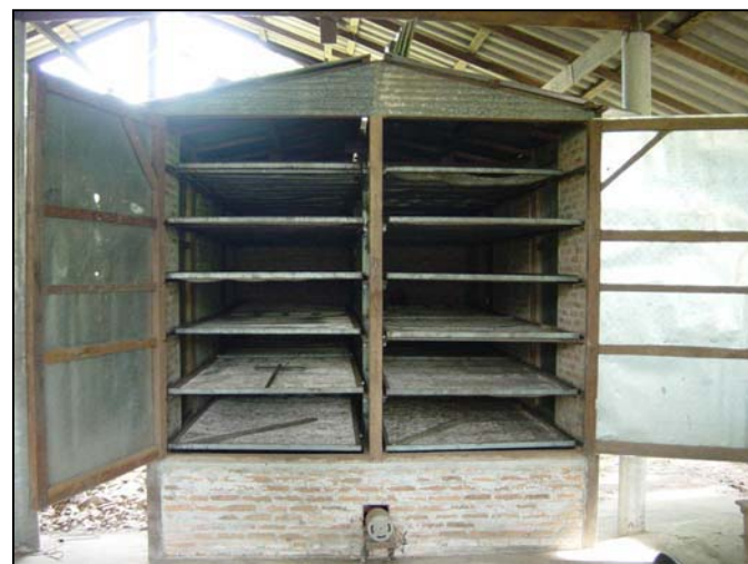
ภาพที่ 3.27 เตาอบลำไยแบบ (ก) เตากระบะ (ข) เตาตู้ และ (ค) เตาป่่ม
