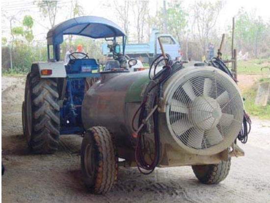
ภาพที่ 5.10 เครื่องกลที่ทันสมัยสำหรับใช้พ่นสารเคมีเกษตรในสวนส้มขนาดใหญ่พิเศษ
