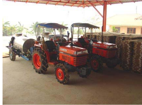
ภาพที่ 5.10 เครื่องกลที่ทันสมัยสำหรับใช้พ่นสารเคมีเกษตรในสวนส้มขนาดใหญ่พิเศษ
