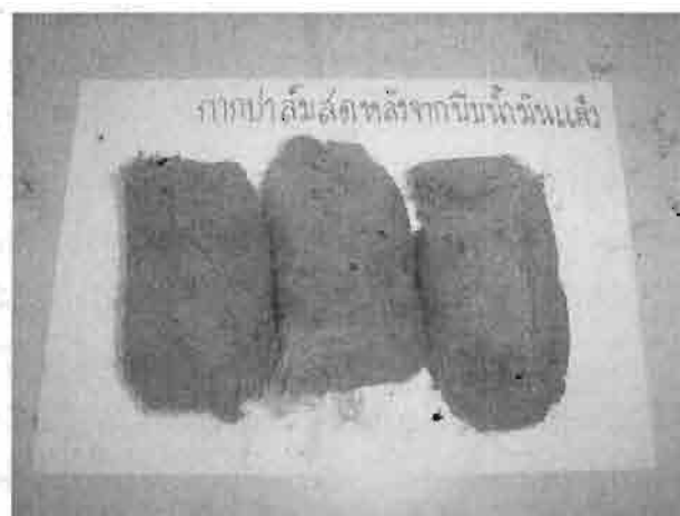
รูปที่ 4.8 แสดงกากที่เหลือจากการบีบน้ำมันแล้ว
