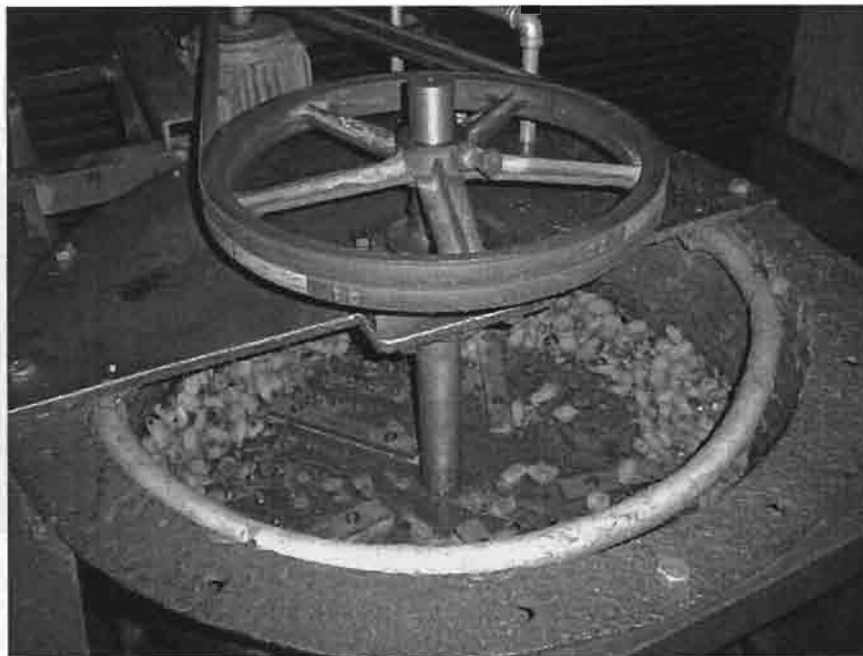
รูปที่ 6. แสดงการแยกเปลือกปาล์มออกจากเมล็ดภายในถัง
