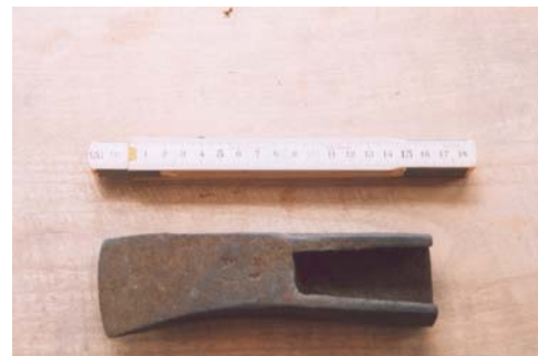
รูปที่ 6.8 มุย หรือขวานแบบดั้งเดิมสำหรับตัดไม้
