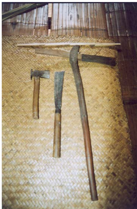
รูปที่ 6.39 ขวานผ่าฟืน พะโต้ และขวานตัดไม้
