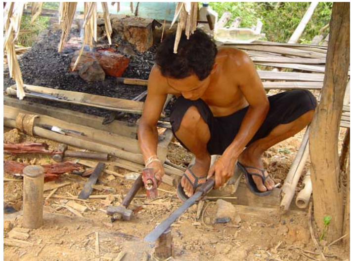
รูปที่ 3.17 ช่างกำลังตีเหล็กแบบวิธีการดั้งเดิม
