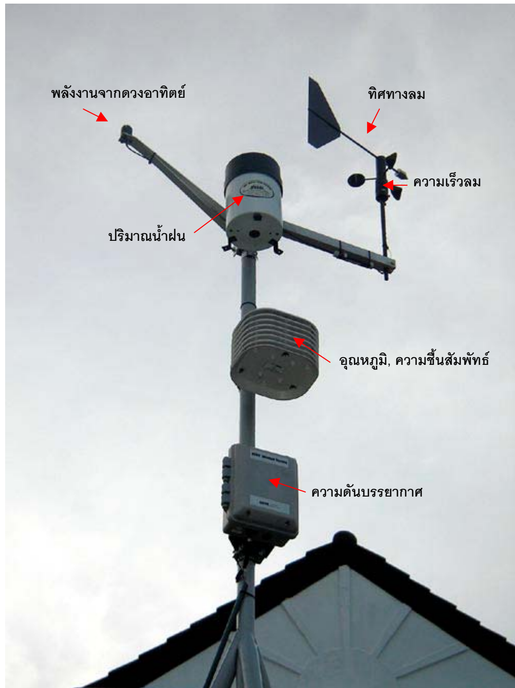
ภาพแสดง ตำแหน่งของเซ็นเซอร์ต่างๆ ของสถานีตรวจอากาศอัตโนมัติ
