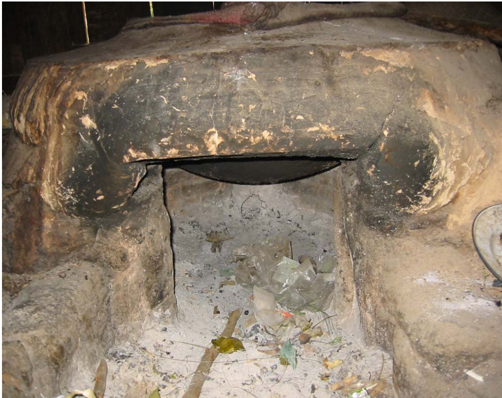
ภาพที่ 22 ภาพเตาแบบเดิมที่ใช้กระทะ ทำให้ความร้อนกระจายและไม่มีตาครอบฐาน
