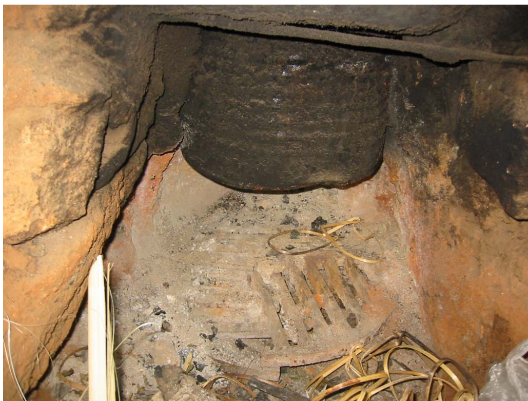
ภาพที่ 22 เตาแบบใหม่ที่มีตาตรงทำให้ใช้ฟืนที่มีขนาดเล็กลง
