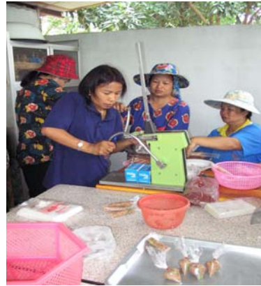
รูปที่ 14 การรัดปากถุงขนมด้วยเครื่องรัดปากถุง
