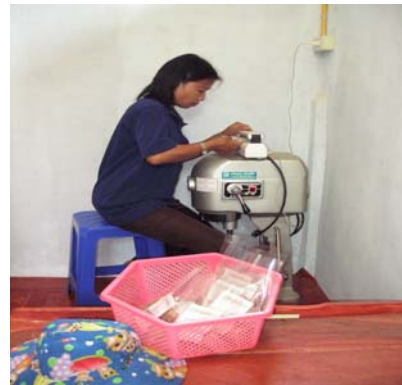
รูปที่ 16 การรัดปากถุงเพื่อแพ็คผลิตภัณฑ์ด้วย เครื่องรัดปากถุง
