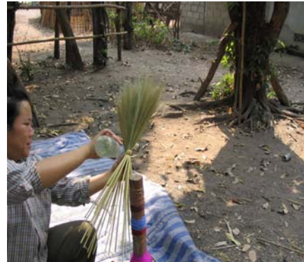
รูปภาพ ก.14 ฉีดน้ำก้านข้าวฟ่างเพื่อป้องกันการ หักระหว่างการถักลาย
