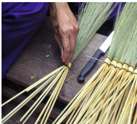
รูปภาพ ก.11 การใช้เหล็กแหลมเจาะรูดอกหญ้าที่มัดเป็นลูก ๆ เพื่อให้ลวดมัดติดกัน
