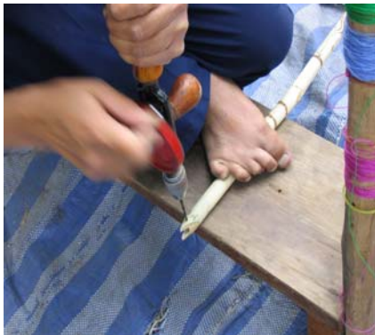
รูปภาพ ก.15 ใช้ส่วานเจาะรูด้ามไม้กวาดเพื่อใส่ ลิ่มเพื่อให้ด้ามยึดแน่นกับตัวไม้ กวาด
