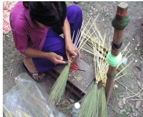
รูปภาพ ก.10 การมัดดอกหญ้ากับก้านข้าวฟ่างเป็นลูก ๆ
