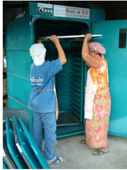
รูปที่ ก.8 นำแผ่นเข้าอบในเครื่องอบลำไย
