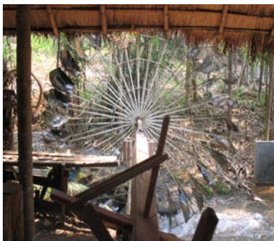
รูปที่ ก.5 การใช้กังหันพลังน้ำ หมุนแกนครกกระเดื่อง
