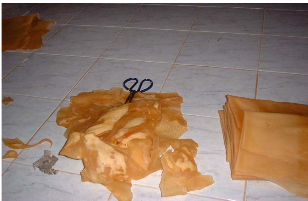
ขั้นตอนที่ 16 นำยางที่เข้าห้องอบแล้วมา ทำการ cutting
