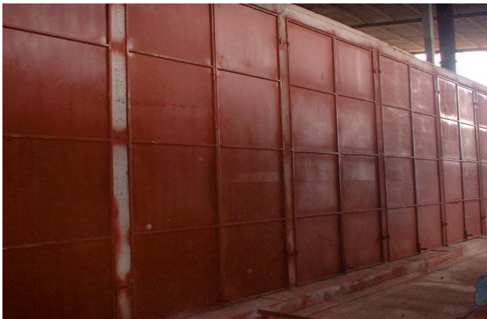
ขั้นตอนที่ 15 นำยางที่สะเด็ดน้ำแล้วเข้าห้องอบควบคุมอุณหภูมิ ประมาณ 3 – 4 วัน
