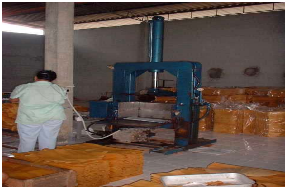
ขั้นตอนที่ 19 นำยางที่ซังน้ำหนักแล้วเข้าเครื่องอัดเบล
