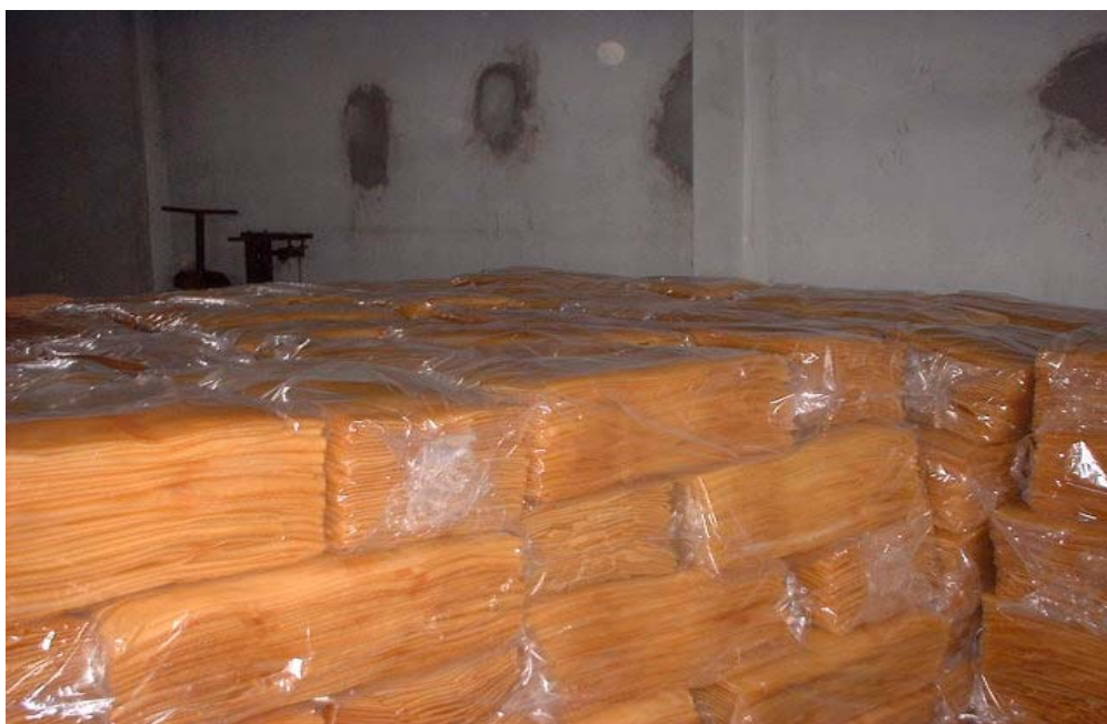
ขั้นตอนที่ 20 นำยางที่อัดก้อนเสร็จแล้ว ใส่อุปเตรียมส่งมอบ
