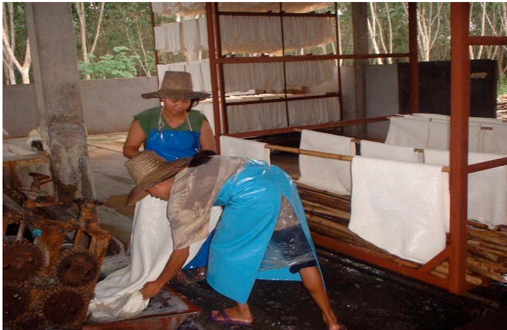
ขั้นตอนที่ 13 น่ายางที่รีดทำดอกเสร็จแล้ว ขึ้นกะตากยาง
