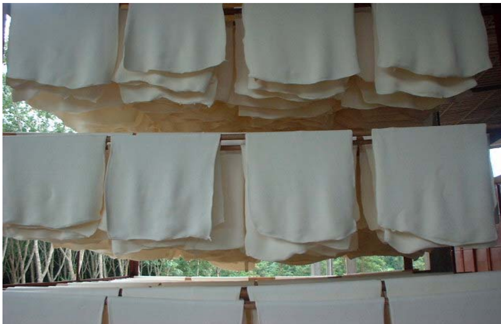
ขั้นตอนที่ 14 ตากยางไว้ประมาณ 1 – 2 ชั่วโมง เพื่อให้สะเด็ดน้ำ
