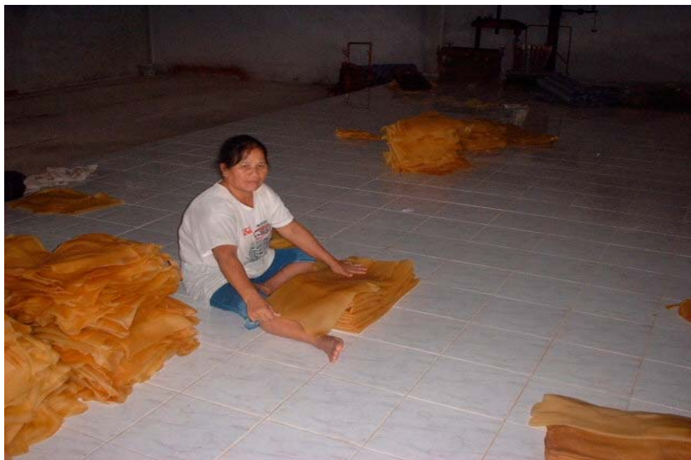
ขั้นตอนที่ 17 พับยางให้ขนาดพอดีกับบล็อกยาง
