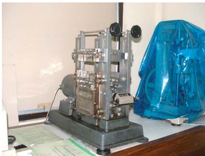
รูปที่ 3.2 เครื่องทดสอบความต้านทานต่อการหักงอ และความต้านทานต่อการขยายของรอยแตก
