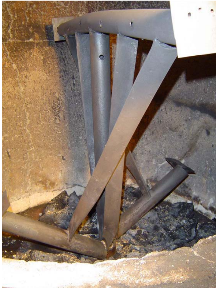
รูปที่ ค.8 แสดงความเสียหายของใบกวาระหว่างการทดสอบ
