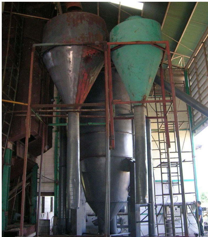
รูปที่ ค.5 แสดงไซโคลนดักเก้าที่เกิดจากการเผาไหม้โดยเพิ่มเป็นจำนวน 2 ตัว
