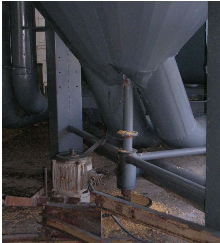
รูปที่ ค.4 แสดงชุดต้นกำลังขับเคลื่อนที่ทำการปรับปรุงให้สามารถตั้งความตึงของโซ่ส่งกำลัง
