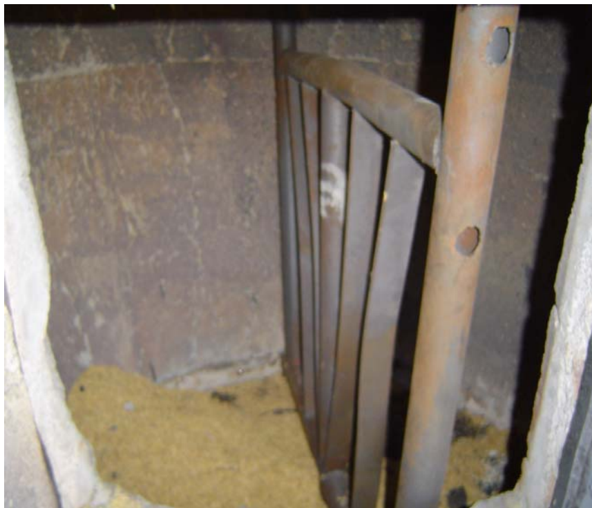
รูปที่ ค.3 แสดงใบกวนที่ใช้ท่อสแตนเลสและมีอากาศหล่อเย็น
