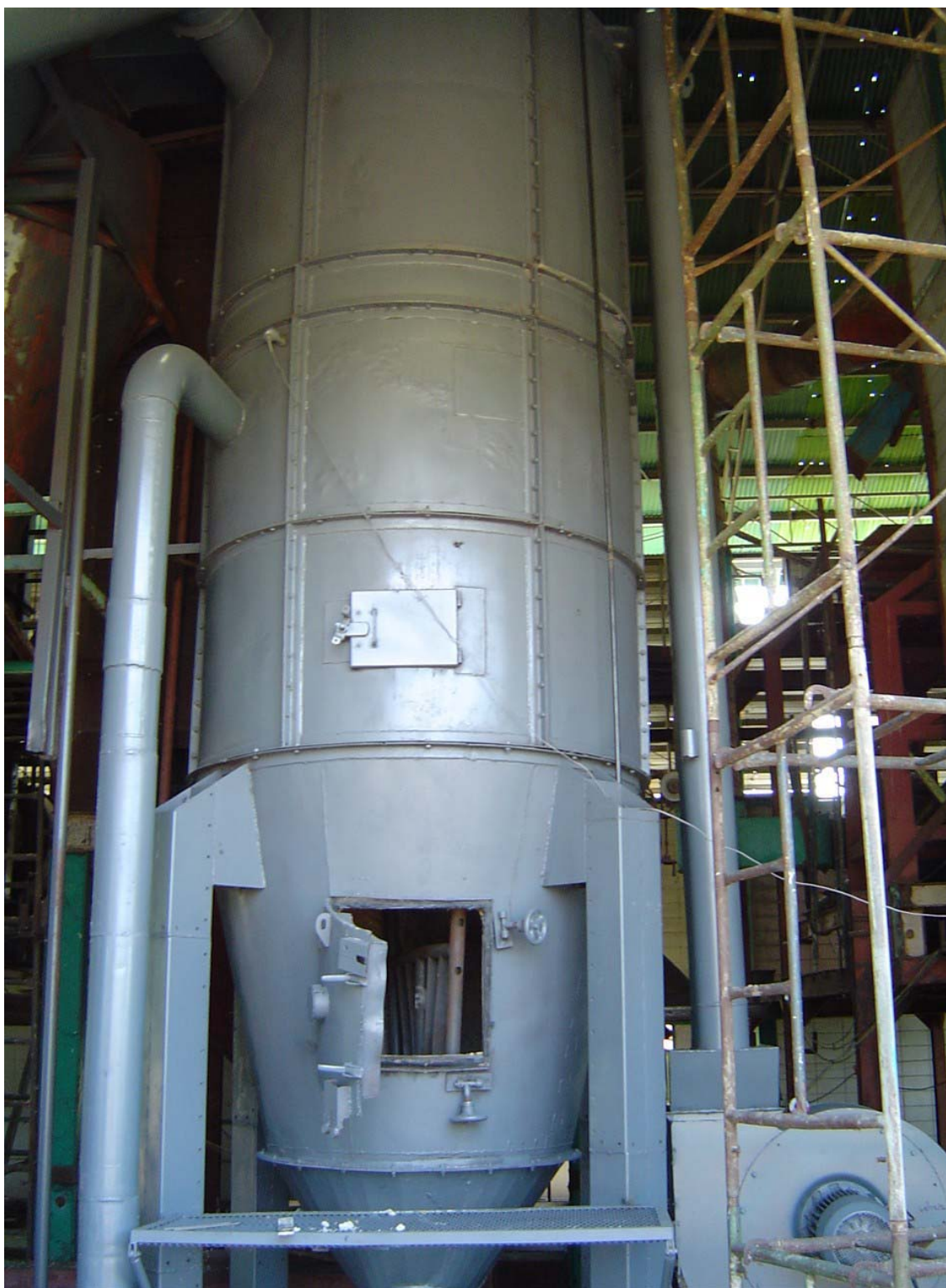
รูปที่ ค.1 แสดงเตาเผาไหม้วอร์เทคฟลูอิดไช้เบดในระดับอุตสาหกรรมขนาดพิกัด 9 MW th
