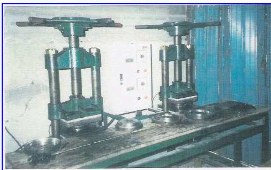
รูปที่ 2.3 เครื่องอัดยางที่เกษตรกรตามชนบทใช้อยู่
