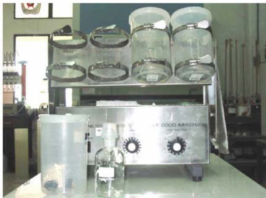
รูปที่ 3.3 การทดลองในส่วนของกระบวนการรีดักชันด้วยเหล็กประจุศูนย์
