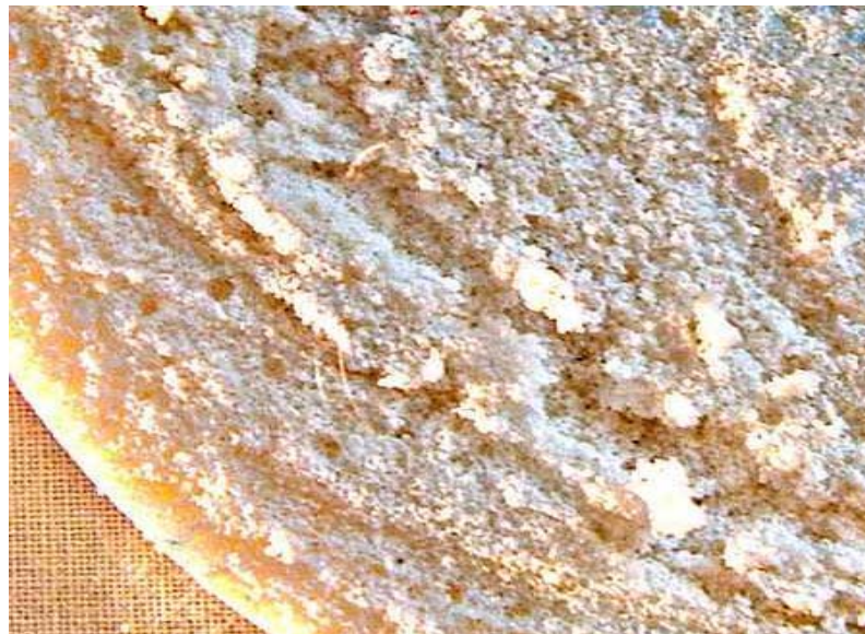
รูปที่ 4.35 ลักษณะผิวหลังการขจัดของชั้นฟองน้ำที่ไม่ได้เคลือบคาร์บอน
