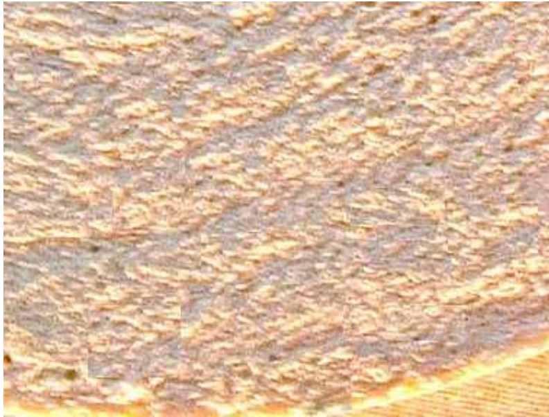
รูปที่ 4.34 ลักษณะผิวก่อนการขจัดของชั้นฟองน้ำที่ได้เคลือบคาร์บอน เพียงอย่างเดียว มีเคลือบคาร์บอนปริมาณ 100 phr
