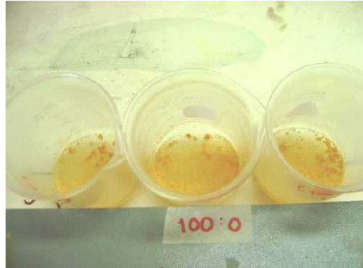
รูปที่ 4.14 ลักษณะกากจีแป้งเหลวที่ย่อยด้วยกรดไนตริกเข้มข้น
