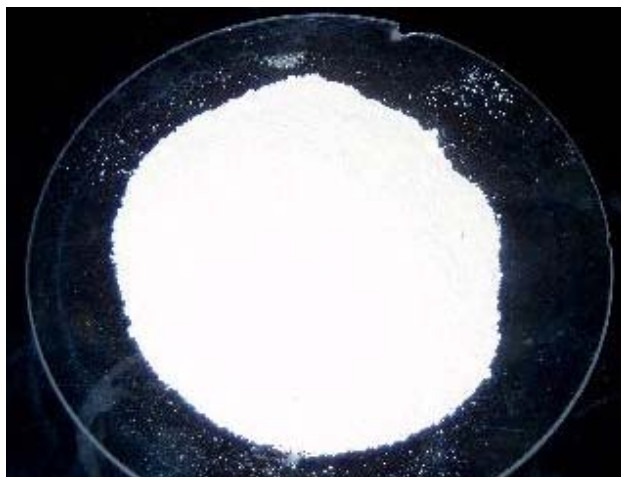
รูปที่ 4.4 ลักษณะกากจีแป้งอบแห้งหลังการอบที่อุณหภูมิ 70 องศาเซลเซียส บดเป็นผงละเอียด
