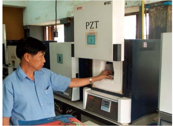
รูปที่ 6 ผู้ช่วยนักวิจัยนำเอาสารประกอบพีแซดที่ไปเข้าเตาเผาพีแซดที่โดยเฉพาะ
