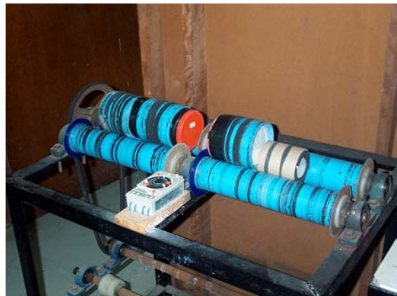
รูปที่ 4 นำเอาผงเคมีของสารประกอบพีแซดที่ไปกลิ้งให้เข้ากัน
