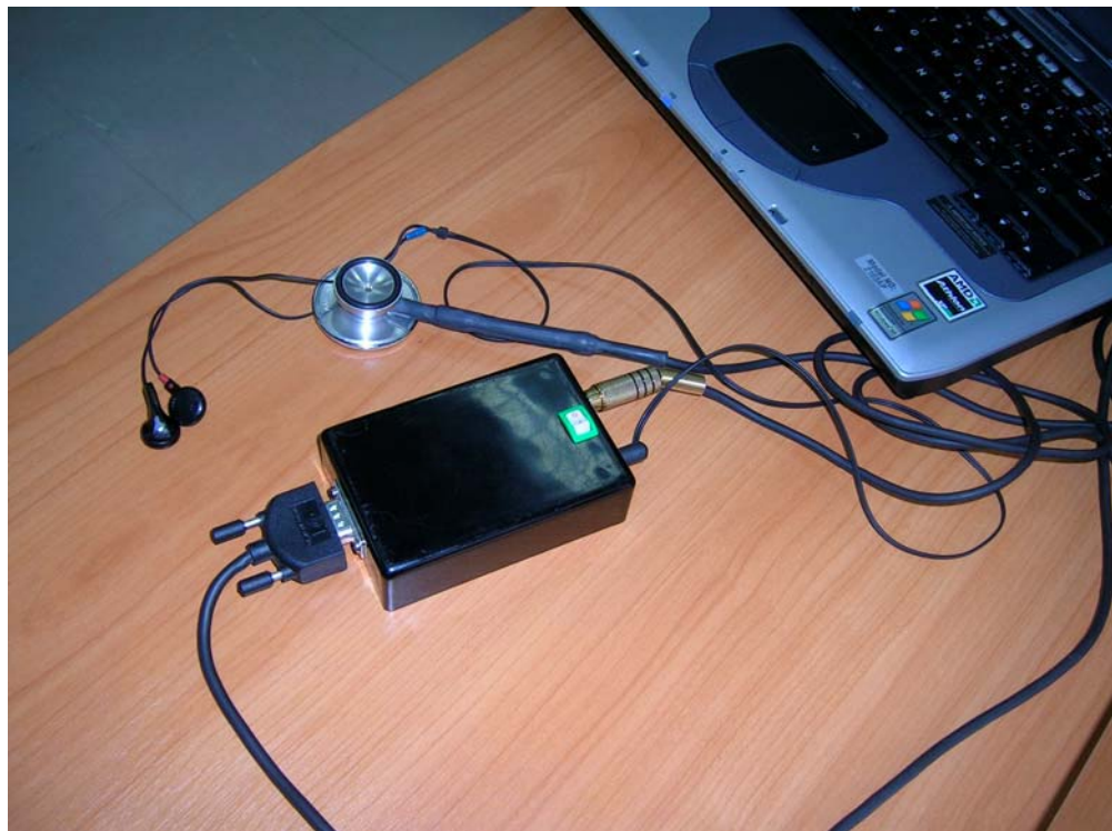
รูปที่ 42 เครื่องต้นแบบวัดเสียงหัวใจใช้ร่วมกับคอมพิวเตอร์แบบหิ้วถือ (Notebook Computer)
