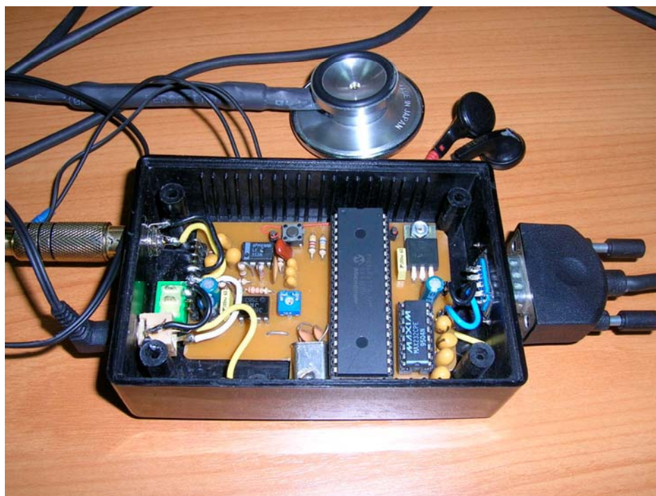
รูปที่ 40 แผงวงจรของเครื่องต้นแบบวัดเสียงหัวใจบรรจุลงกล่องพร้อมใช้งาน
