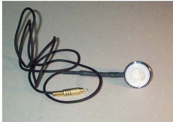
รูปที่ 46 สเต็ทโทรสโคปที่บรรจุพีแชนด์ที่ทรานสดิวเซอร์พร้อมกับดัดแปลงสายสัญญาณเรียบร้อยแล้ว
