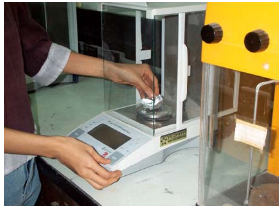
รูปที่ 2 นำเอาผงเคมีของสารประกอบพีแซดที่ไปชั่งน้ำหนัก
