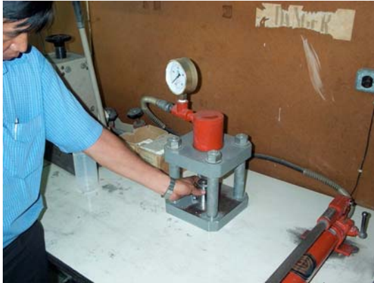
รูปที่ 5 ผู้ช่วยนักวิจัยนำเอาผงพีแซดไปอัดขึ้นรูป
