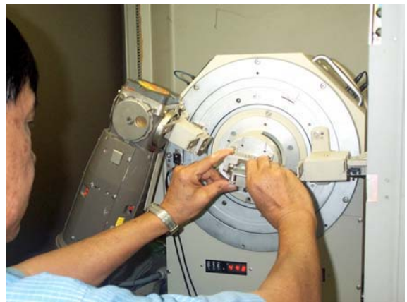
รูปที่ 10 นำไปทำซ้ำไฟฟ้า และหา XRD โดยเครื่องเอ็กเรย์ดิฟแฟกชัน (X-Ray Diffraction)
