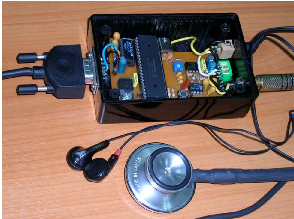
รูปที่ 41 แผงวงจรของเครื่องต้นแบบวัดเสียงหัวใจบรรจุลงกล่องพร้อมใช้งาน (มองอีกมุมหนึ่ง)
