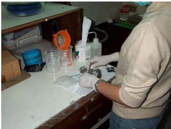
รูปที่ 3 นำเอาผงเคมีของสารประกอบพีแซดที่ไปตำให้เป็นผงละเอียด
