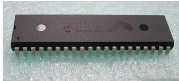
รูปที่ 23 รูปร่างภายนอกไอซีไมโครคอนโทรลเลอร์เบอร์ PIC 16F877A
