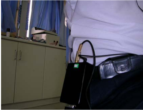
รูปที่ 43 แสดงการวัดเสียงหัวใจของเครื่องต้นแบบที่สามารถพกพาติดตัวได้
