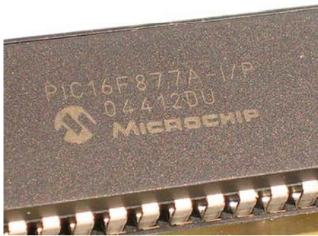
รูปที่ 23 รูปร่างภายนอกไอซีไมโครคอนโทรลเลอร์เบอร์ PIC 16F877A
