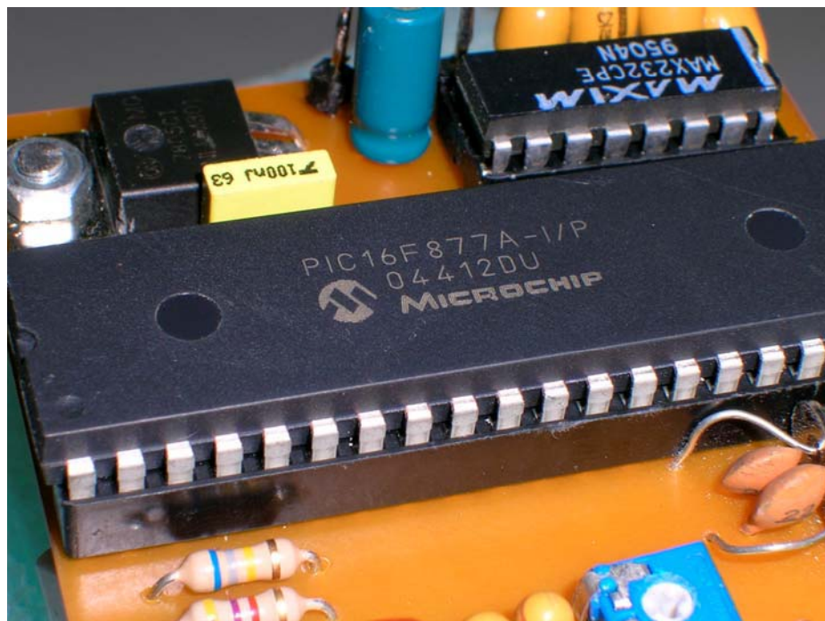
รูปที่ 38 แผงวงจรของเครื่องต้นแบบวัดเสียงหัวใจโฟกัสที่ไม่โครคอนโทรลเลอร์
