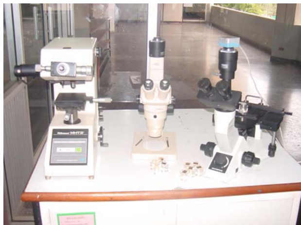
ภาพที่ 3.5 เครื่องทดสอบความแข็งไมโครวิกเกอร์ ยี่ห้อ Mutsuzawa รุ่น MHT2 ที่ใช้ในการทดสอบ
