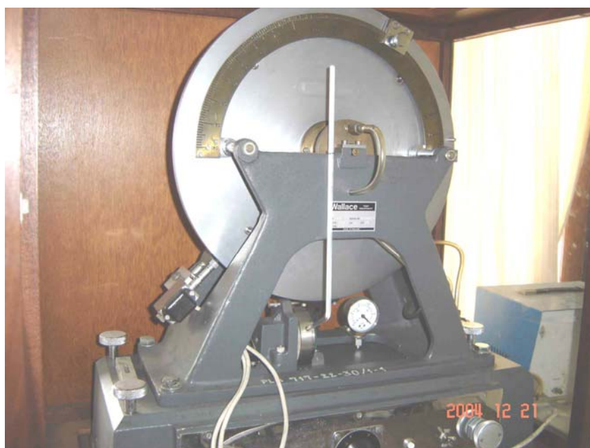
รูปที่ 4 ลักษณะทั่วไปของเครื่องวัดความกระด้างตัวของยางแบบ Dunlop tripsometer
