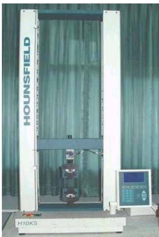
รูปที่ 2 ลักษณะทั่วไปของเครื่อง Tensometer (ผลิตโดยบริษัท Hounsfield Co., Ltd.)
