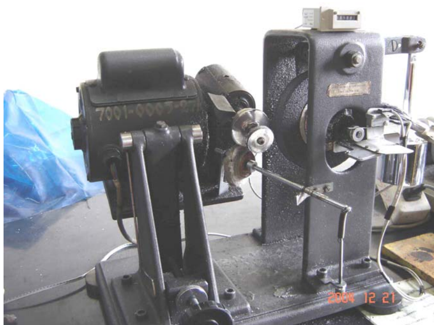
รูปที่ 5 ลักษณะทั่วไปของเครื่องทดสอบความทนทานต่อการสึกหรอแบบ Akron
