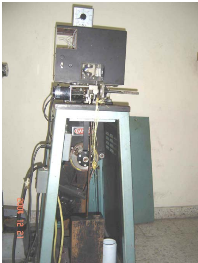
รูปที่ 6 ลักษณะทั่วไปของเครื่องวัดความร้อนสะสมที่เกิดขึ้นในยางแบบ Goodrich Flexometer
