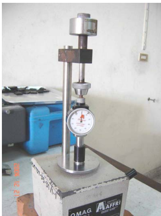
รูปที่ 3 ลักษณะทั่วไปของเครื่องวัดความแข็งแบบ Shore A
