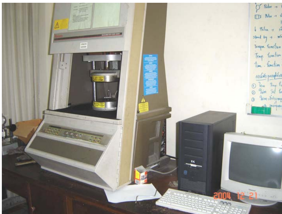
รูปที่ 1 ลักษณะทั่วไปของเครื่องทดสอบการดึงของยาง ODR 2000
