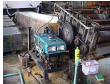
รูปที่ 2-14 จักรรีดแบบใช้เครื่องยนต์ดีเซล
