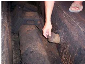
รูปที่ 3-27 การหาวัดคุมาปิดท่อให้ความร้อนของเตารุ่นปี 2538
