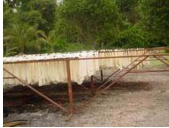
รูปที่ 3-31 การตากยางแผ่นดิบแล้วค่อนนำไปรมภายหลัง
