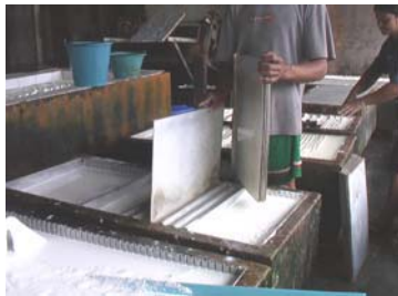
รูปที่ 2-8 คนงานทำการเสียบแผ่นตะกวด ต้องทำอย่างระมัดระวังเพื่อไม่ให้เกิดฟอง
