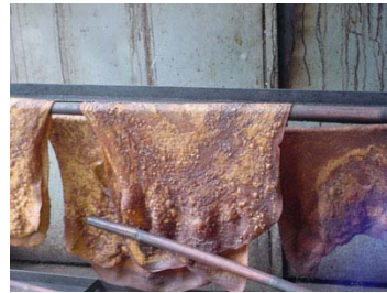
รูปที่ 3-48 เศษยางที่เกิดจากฟองในตะก รูปที่ 3-49 ฟองยางที่นำมารีดเป็นแผ่นแล้วนำเข้ารม
