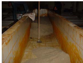
รูปที่ 5 รางลำเลียงยางของสหกรณ์ดอนชีเหล็ก เทพื้นให้มีความลึกของรางลดลง
