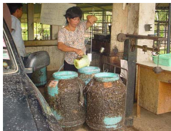
รูปที่ 3-5 พนักงานทำการตักน้ำยางจากแต่ละถังมาผสมกันก่อนนำไปวัด DRC
