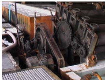
รูปที่ 2-13 จักรรีดแบบใช้มอเตอร์ไฟฟ้า
