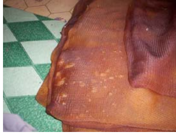
รูปที่ 3-44 ลักษณะยางฟองที่เกิดจากความร้อนในห้องรมสูงเกินไป
