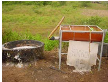
รูปที่ 3-50 อ่างรองรับน้ำล้างภาชนะบรรจุน้ำยางเพื่อให้น้ำยางที่เททิ้งจับตัวเป็นก้อน
