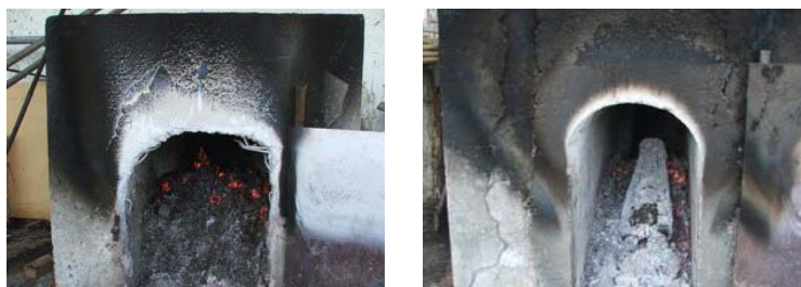
รูปที่ 15 ขนาดเตา : (ก) ขนาดเตาเดิม (ข) ขนาดเตาที่ปรับปรุงแล้ว
