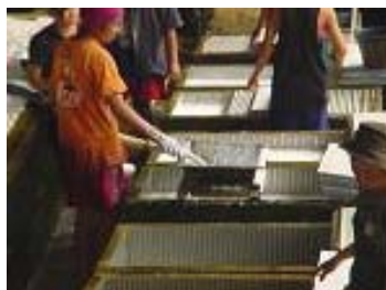
รูปที่ 20 การกรองน้ำยางขณะถายน้ำยางลงในตะกง
