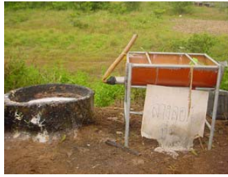
รูปที่ 22 อ่างรองรับน้ำล้างภาชนะบรรจุน้ำยางเพื่อให้ น้ำยางที่เททิ้งจับตัวเป็นก้อน
