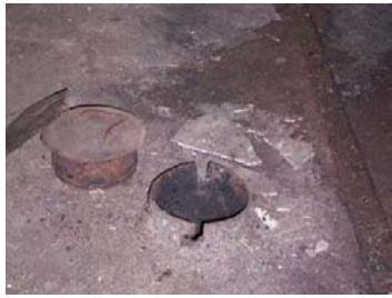
รูปที่ 3-21 ท่อให้ความร้อนของเตารุ่นปี 2537 ที่ไม่มีลักษณะการกระจายความร้อน
