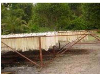
รูปที่ 16 การตากยางแผ่นดิบแล้วค่อยนำไปรมภายหลัง
