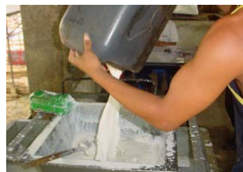
รูปที่ 3-46 การกรองน้ำยางสดในขั้นการเทลงบ่อรวมน้ำยาง
